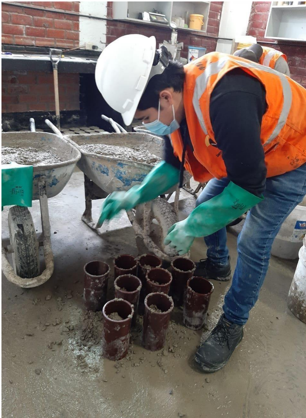
Figura: Foto de muestreo de probetas.
