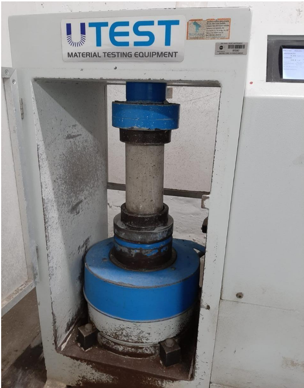
Figura: Foto de ensayo de resistencia a la compresión.
