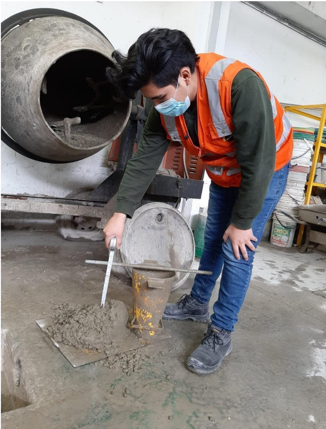
Figura: Foto de ensayo de trabajabilidad - slump.
