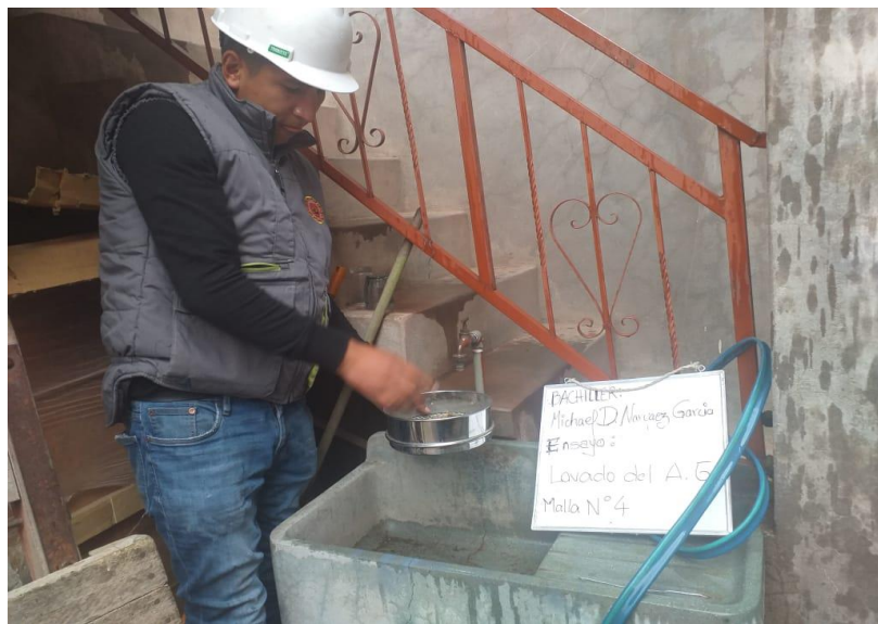
FOTOGRAFIA N° 2: SE MUESTRA LAVANDO EL AGREGADO GRUESO
