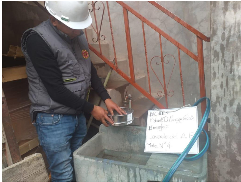
FOTOGRAFIA N° 1: SE MUESTRA LAVANDO EL AGREGADO
