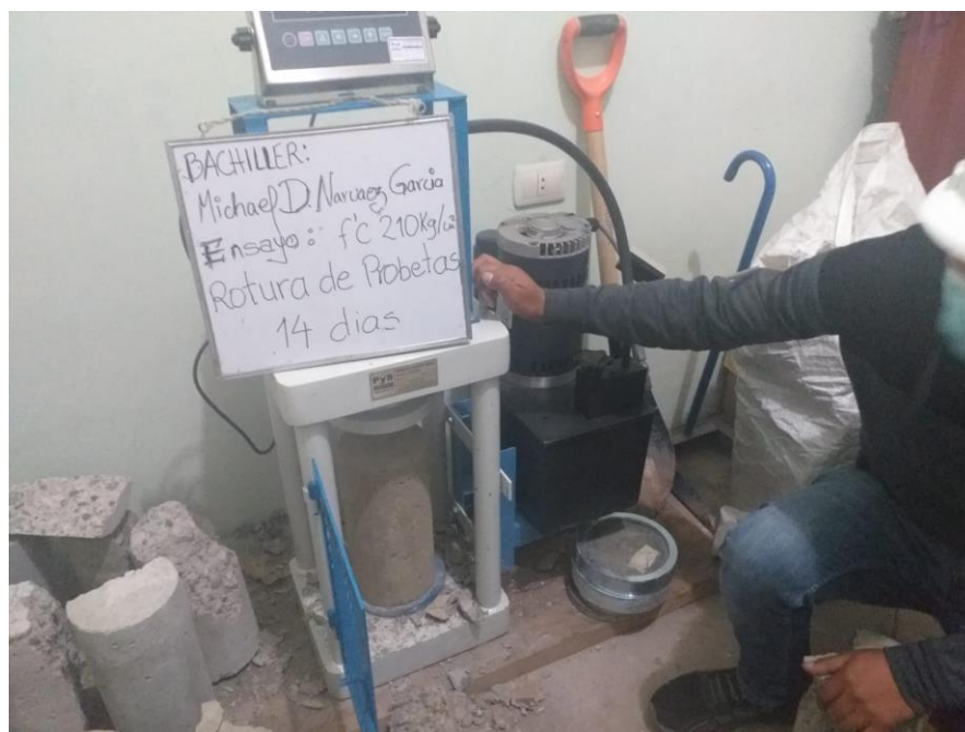
FOTOGRAFIA N° 10: REALIZANDO LA ROTURA DE PROBETA A LOS 14 DIAS
