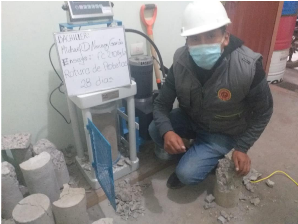
FOTOGRAFIA N° 11: REALIZANDO LA ROTURA DE PROBETA A LOS 28 DIAS
