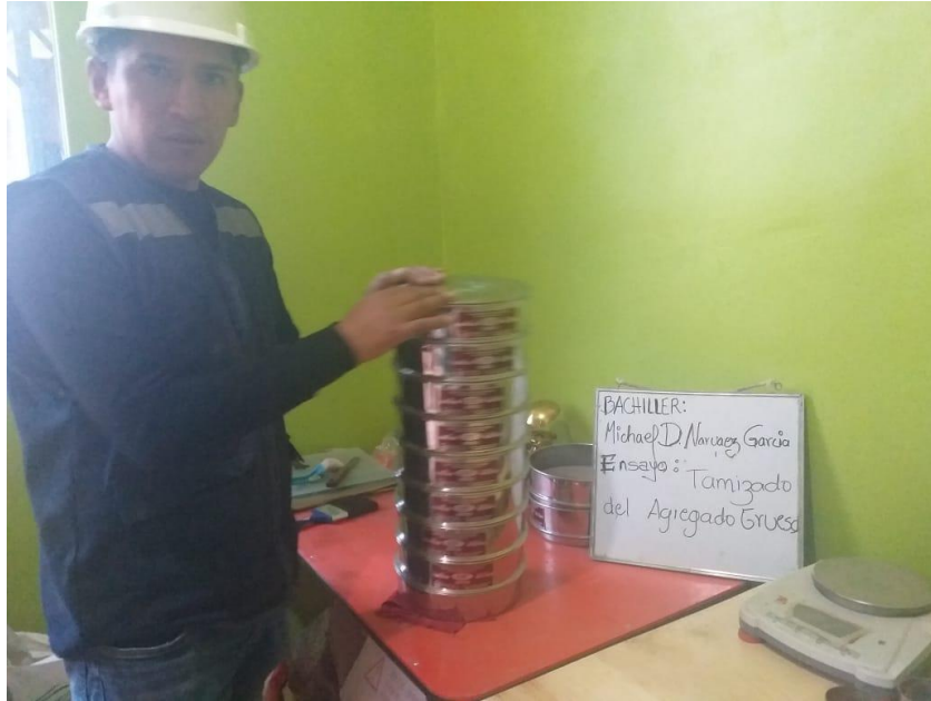
FOTOGRAFIA N° 7: REALIZANDO EL TAMIZADO DE AGREGADO GRUESO
