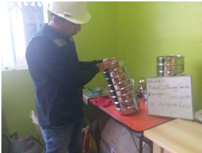
FOTOGRAFIA N° 7: REALIZANDO EL TAMIZADO DE AGREGADO GRUESO
