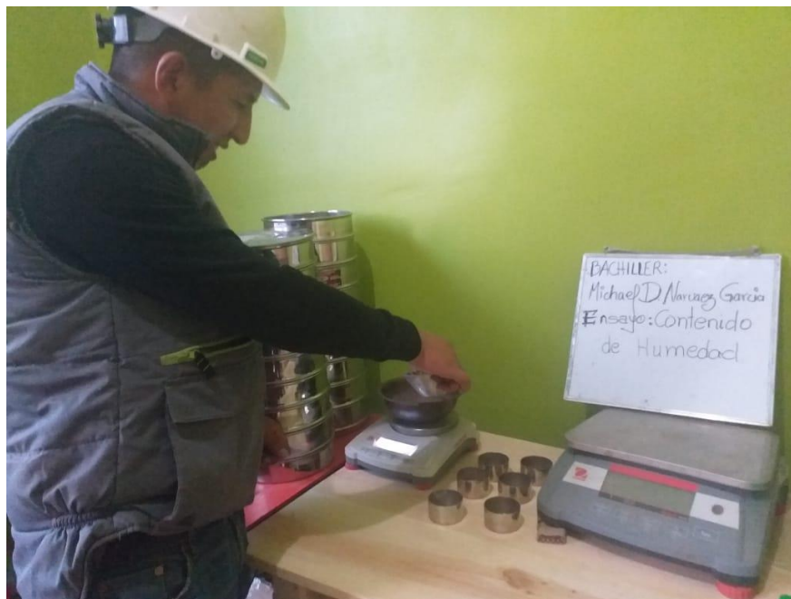
FOTOGRAFIA N° 4: REALIZANDO EL ENSAYO DE CONTENIDO DE HUMEDAD
