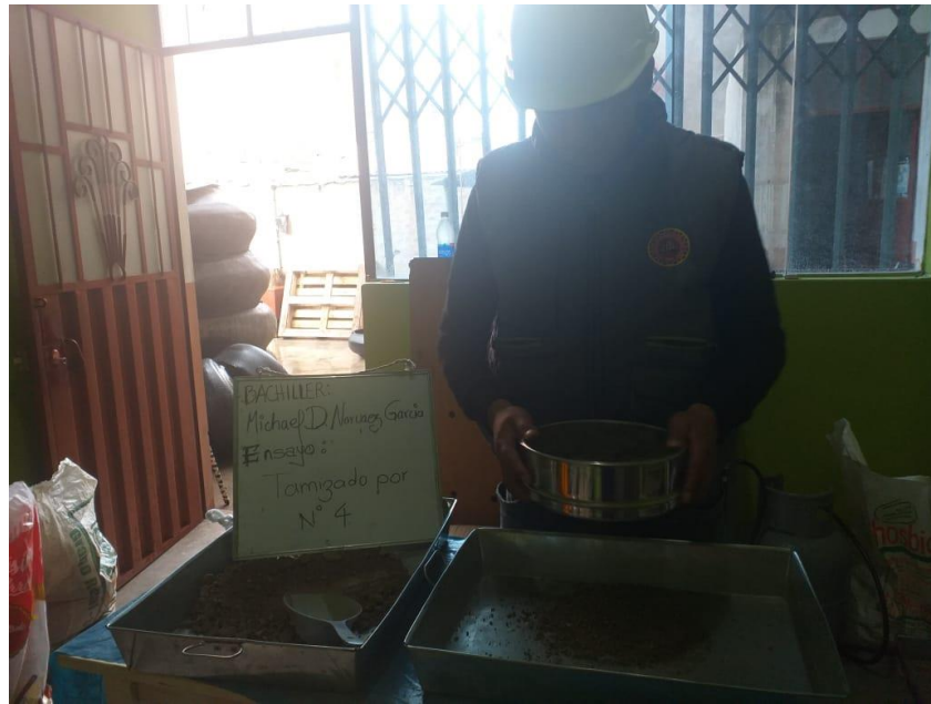
FOTOGRAFIA N° 3: SE MUESTRA EL TAMIZADO POR EL TAMIZ N°4
