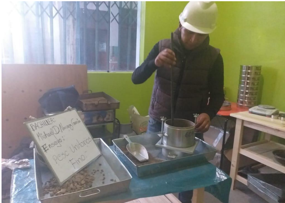
FOTOGRAFIA N° 5: REALIZANDO EL ENSAYO DE PESO UNITARIO DE AGREGADO FINO
