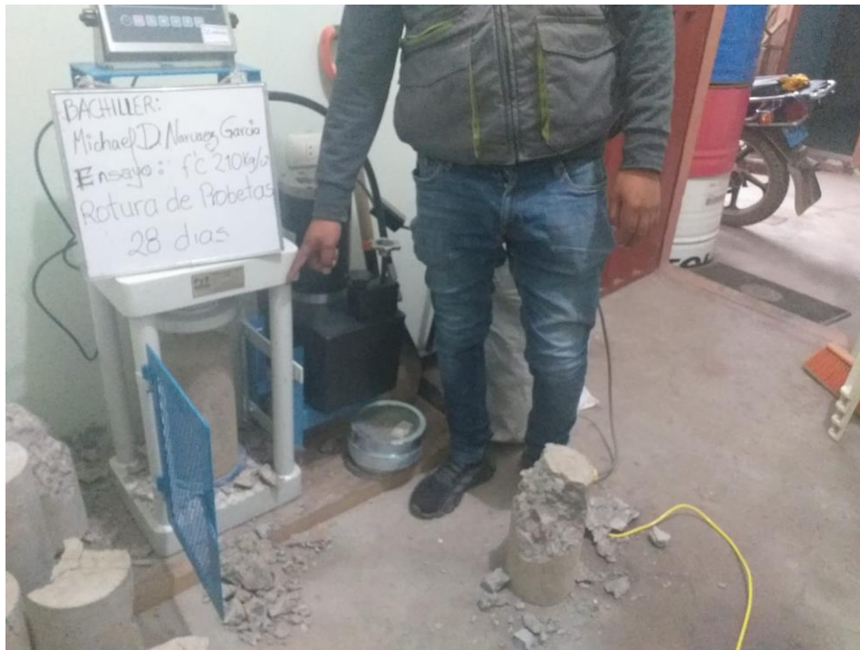
FOTOGRAFIA N° 12: REALIZANDO LA ROTURA DE PROBETA A LOS 28 DIAS
