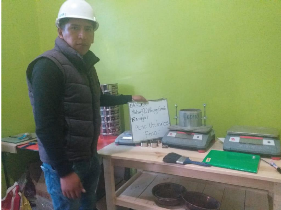
FOTOGRAFIA N° 5: REALIZANDO EL ENSAYO DE PESO UNITARIO DE AGREGADO FINO
