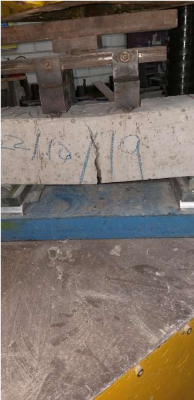
Descripción: Ensayo de resistencia a flexión mediante la rotura de viga simplemente apoyada, con carga aplicada a tercios de la viga laboratorio (LEM)(UNI) ensayo de tracción.
