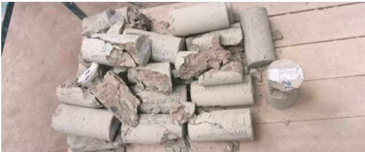
Figura 38: Desechos de probetas después de ensayo de compresión, laboratorio de ensayo de materiales (LEM-FIC-UNI)
