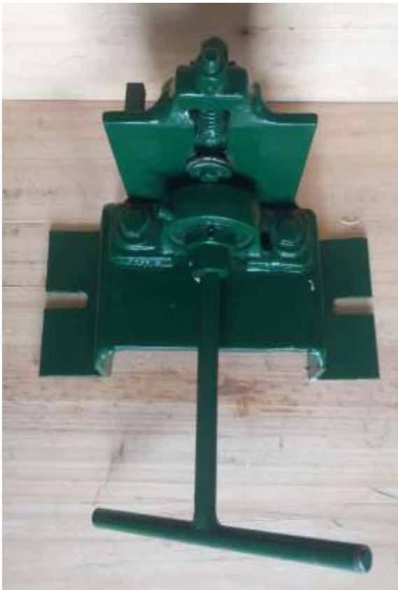
Figura 23: Dispositivo para fabricar fibras de acero, vista trasera
