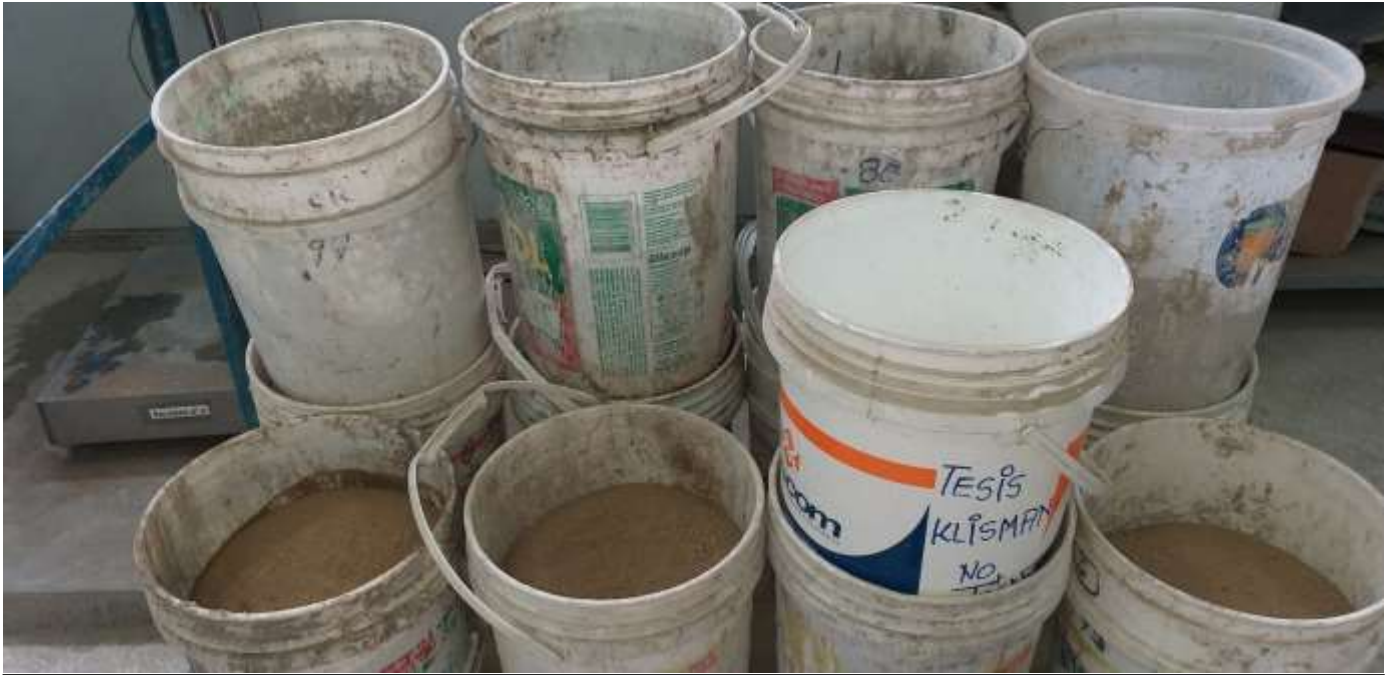
Descripción: Preparación y pesado de materiales para el mezclado, tanda de 0.030 de volumen.
