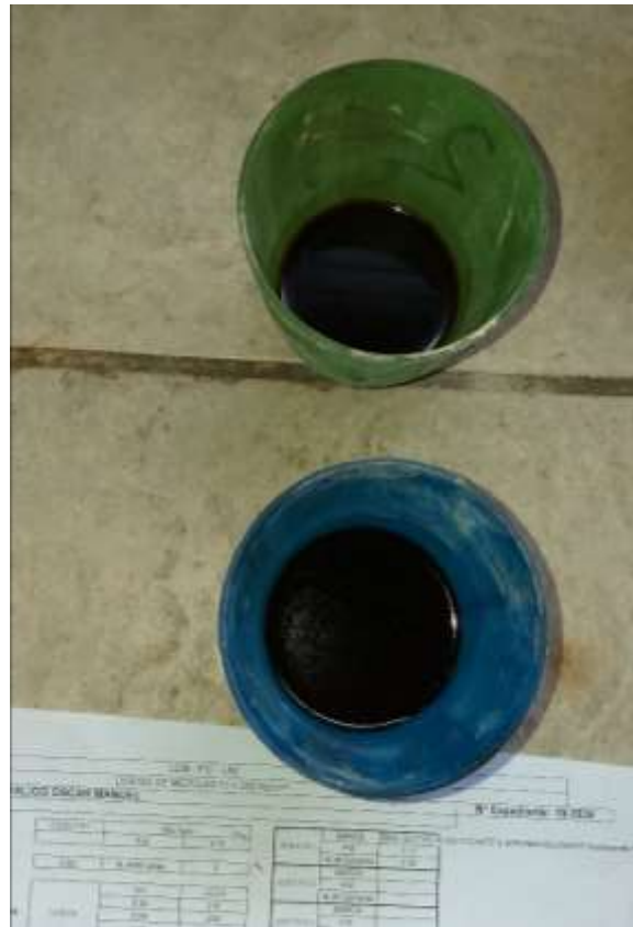
Figura 36: Medición de aditivo plastificante en gramos, laboratorio de ensayo de materiales (LEM-FIC-UNI)
