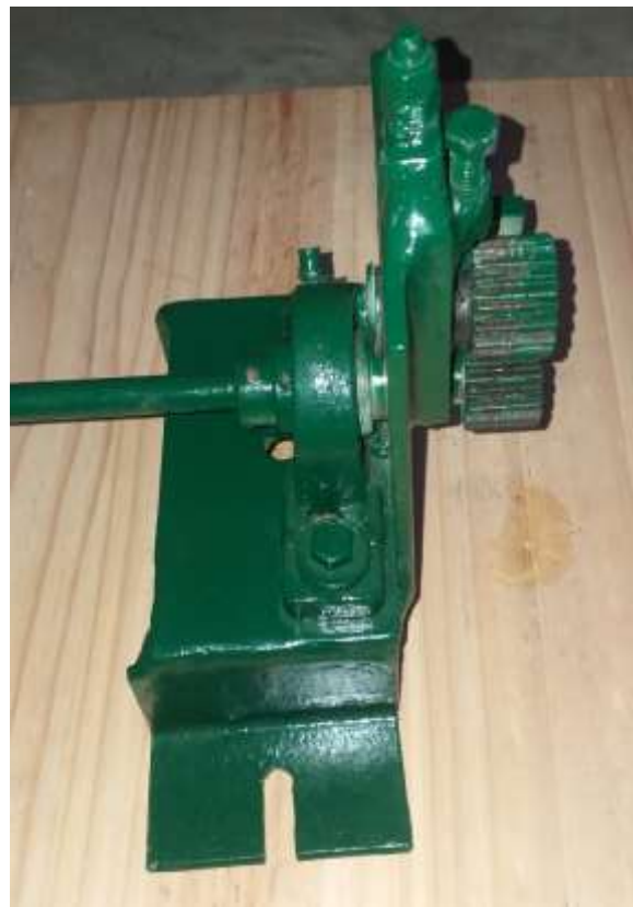
Figura 22: Dispositivo para fabricar fibras de acero, vista lateral
