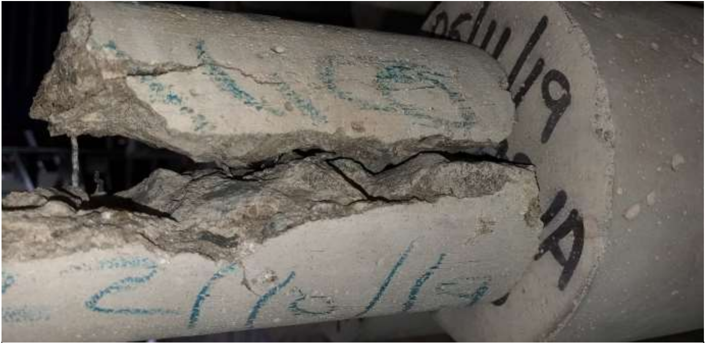
Descripción: Probeta cilíndrica después de rotura, ensayo de tracción, laboratorio (LEM)(UNI)
