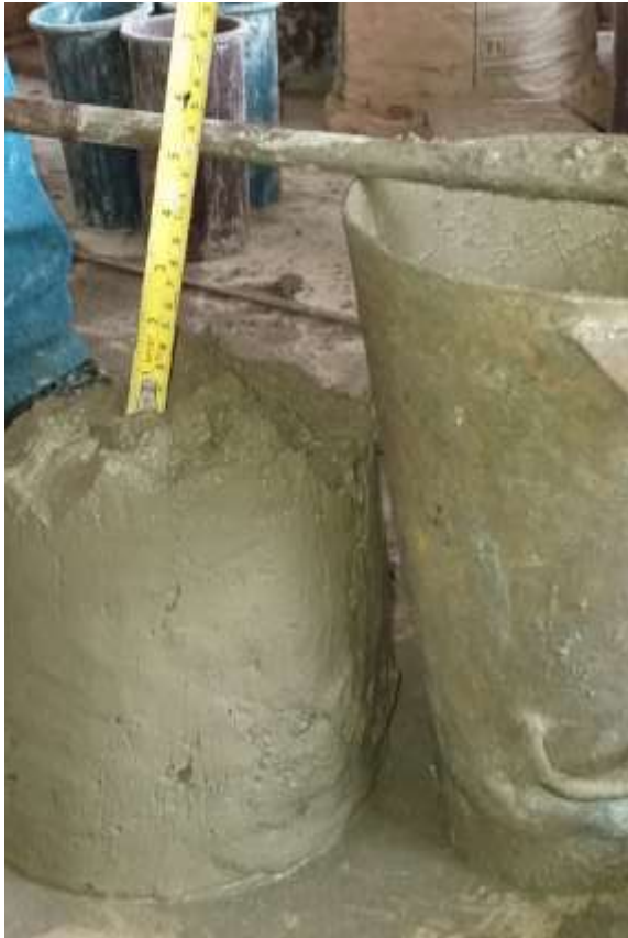
Figura 37: Ensayo de consistencia, mediante cono de abrams, laboratorio de ensayo de materiales (LEM-FIC-UNI)
