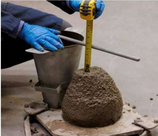
Figura 8: slump de concreto convencional
