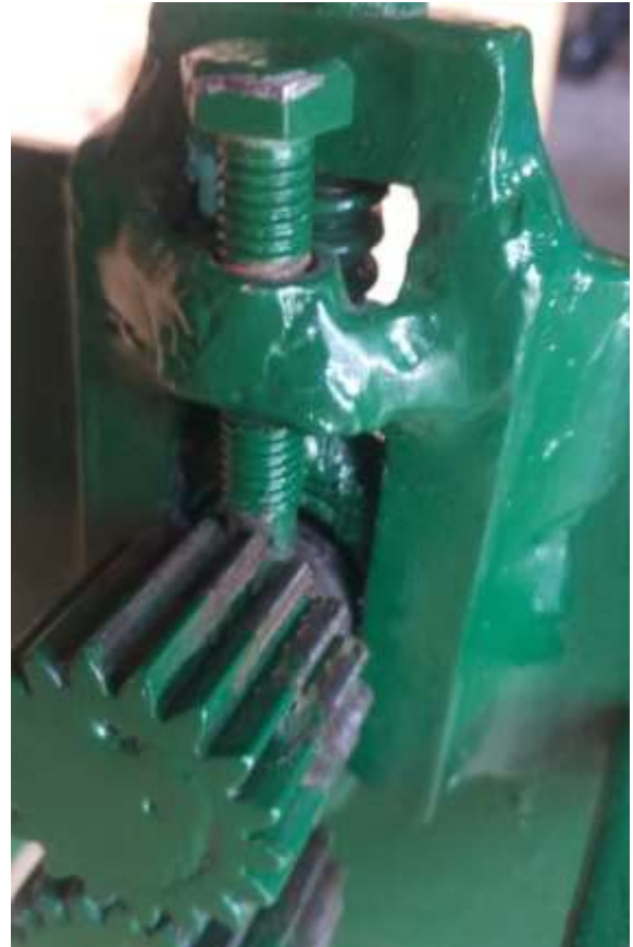
Figura 18: Dispositivo para fabricar fibras onduladas – 2do perno regulador
