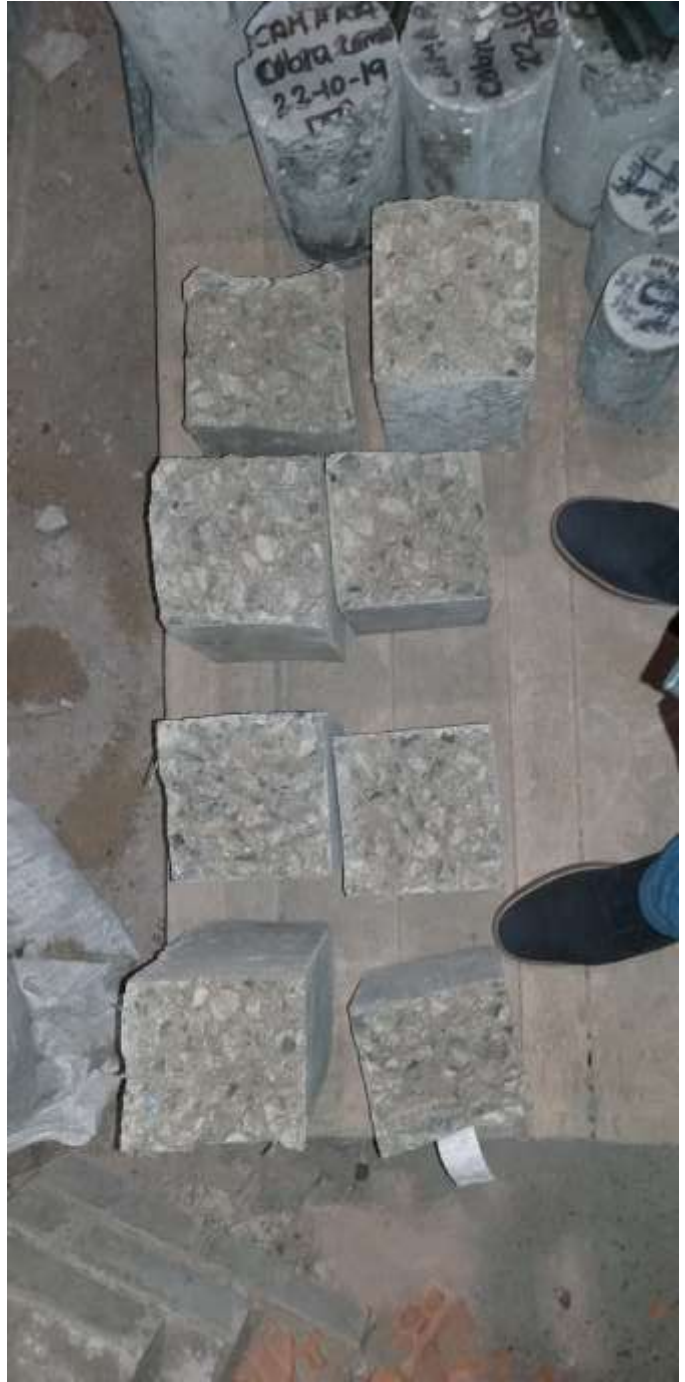
Descripción: Vigas después de Ensayo de resistencia a flexión mediante la rotura de viga simplemente apoyada, con carga aplicada a tercios de la viga laboratorio (LEM)(UNI) ensayo de tracción.
