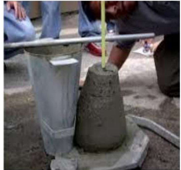
Figura 7: slump de concreto fibroreforzado
