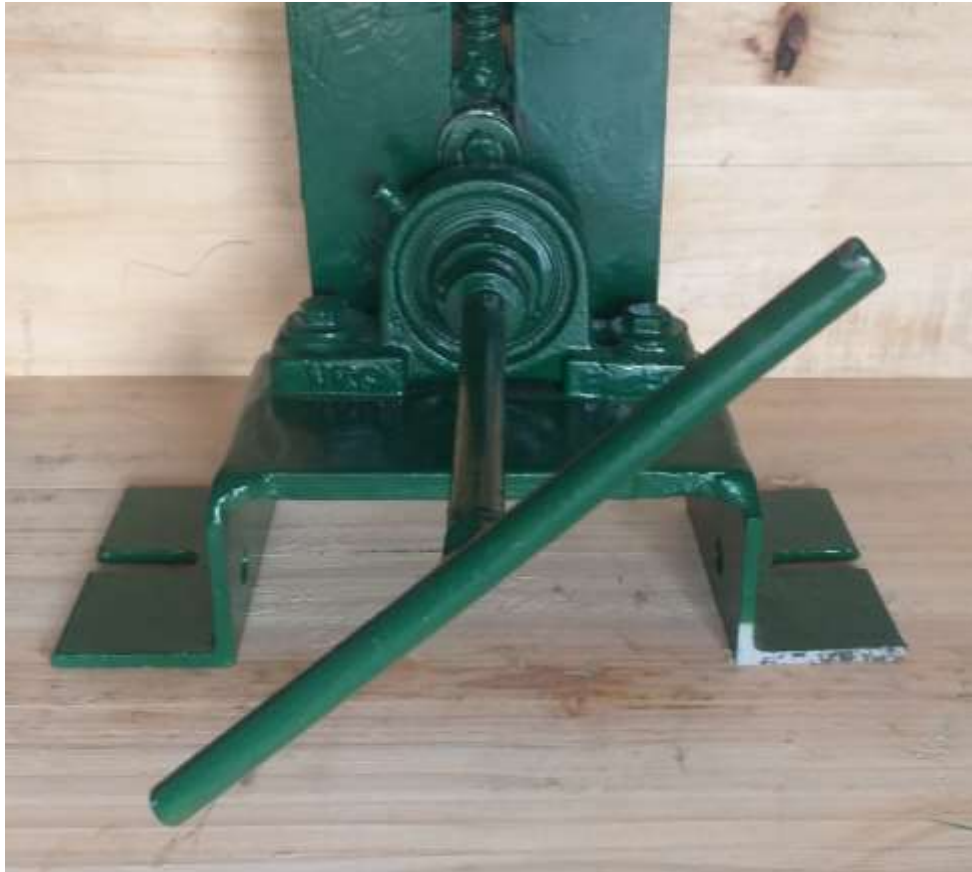
Figura 17: Dispositivo para fabricar fibras onduladas – rodaje, eje y palanca giratoria
