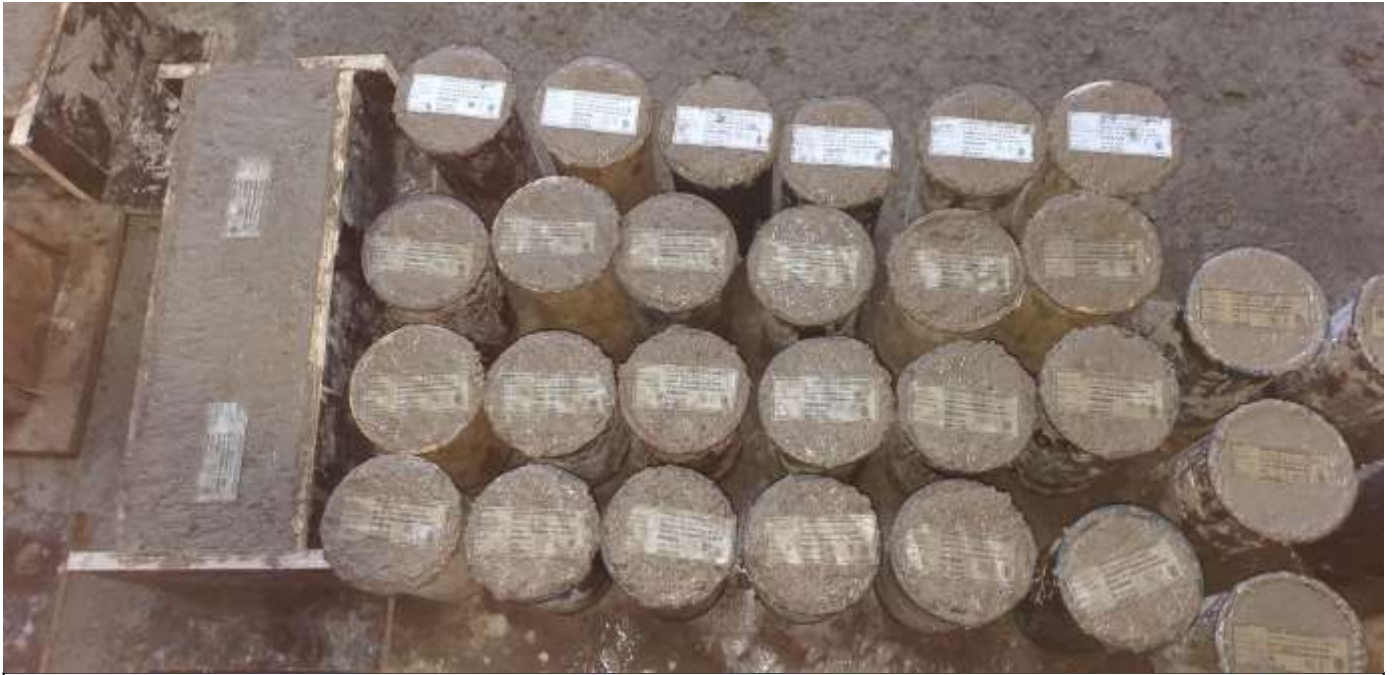
Descripción: Etiqueta en 24 probetas cilíndricas y 4 vigas
