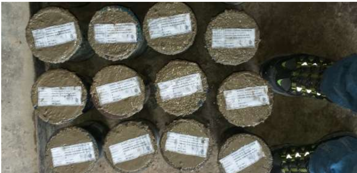
Figura 35: Preparación de probetas cilíndricas para ensayo de compresión, laboratorio de ensayo de materiales (LEM-FIC-UNI)
