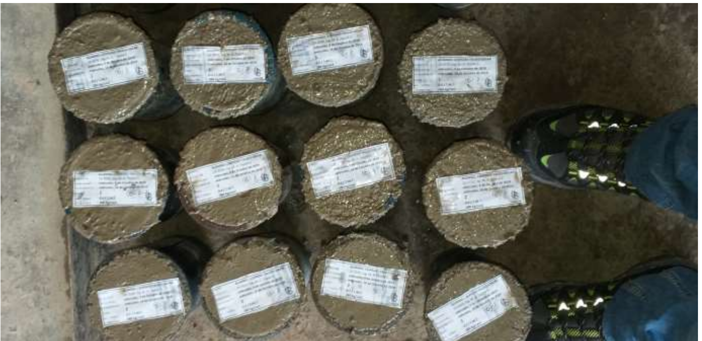
Descripción: Elaboración de probetas cilíndricas para ensayo de compresión, probetas para diseño preliminar.
