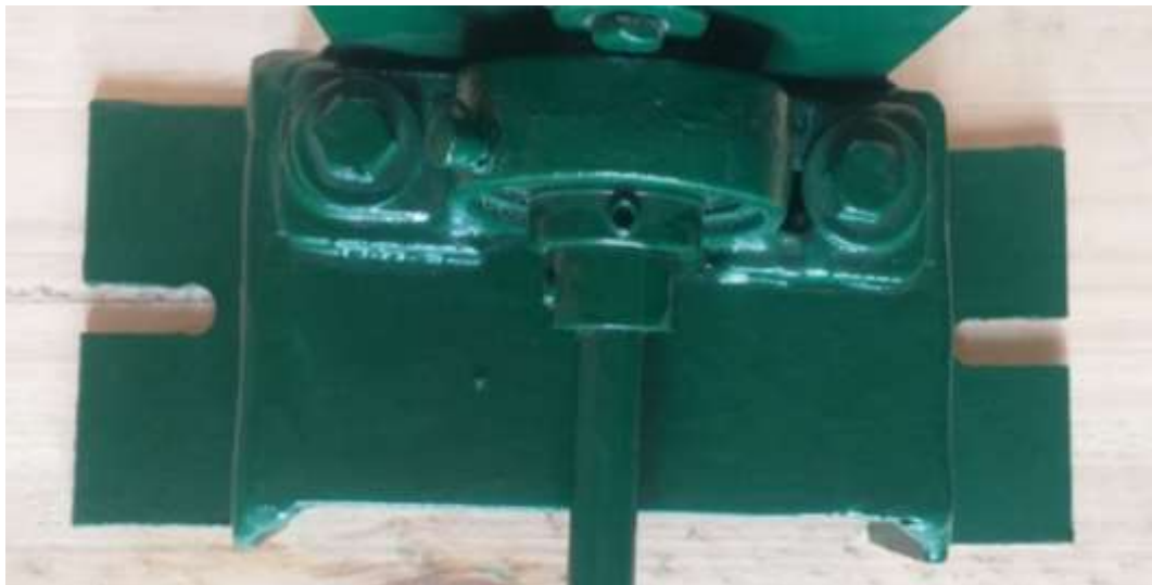
Figura 20: Dispositivo para fabricar fibras onduladas – perforaciones para anclar la estructura mediante pernos, a una mesa de trabajo
