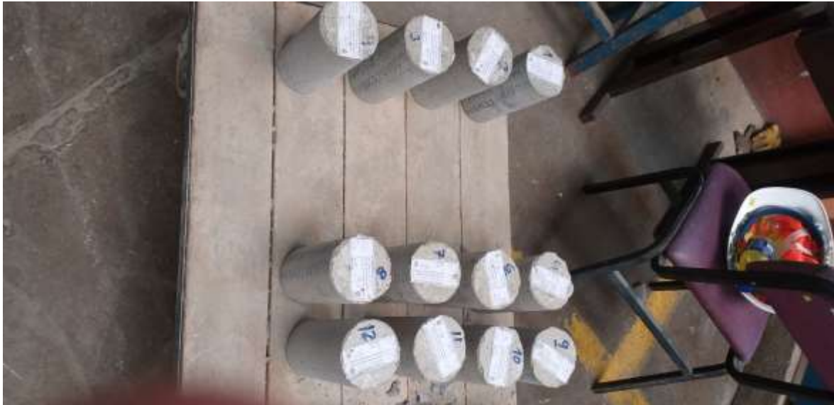
Figura 40: Probetas a los 7 días de curado, laboratorio de ensayo de materiales (LEM-FIC-UNI)
