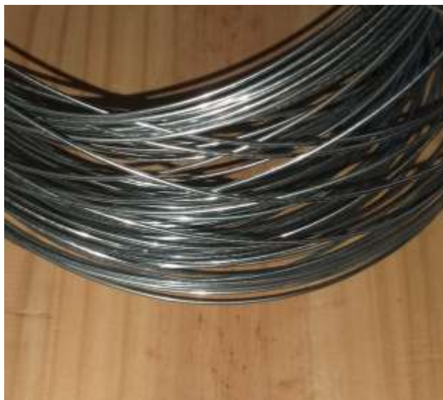
Figura 24: Alambre galvanizado calibre 16, sacar del empaque
