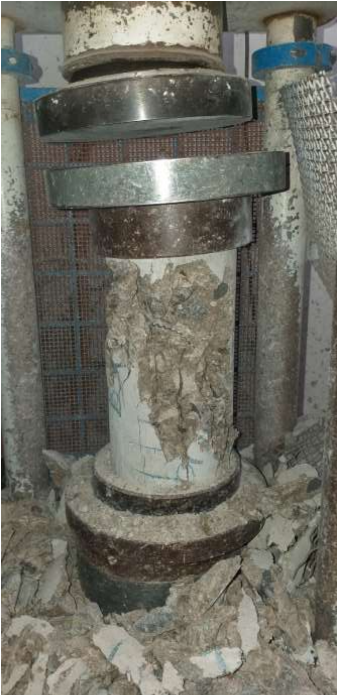
Descripción: Ensayo de resistencia a compresión de probetas cilíndricas laboratorio (LEM)(UNI).
