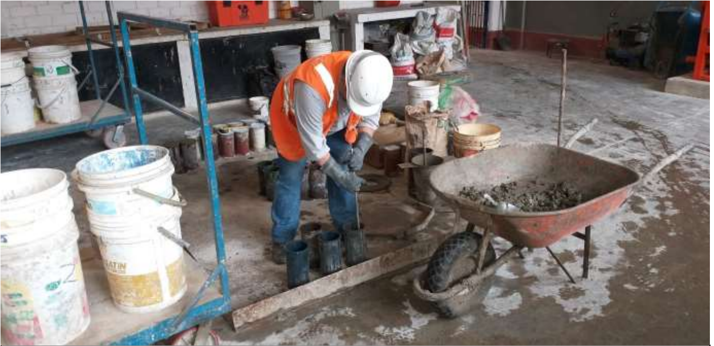
Descripción: Elaboración de probetas cilíndricas para ensayo de compresión axial y diametral.
