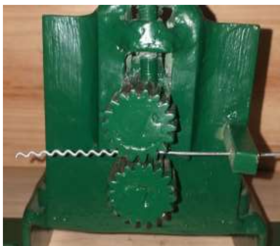
Figura 27: Dispositivo para fabricar fibras, producción de fibras onduladas
