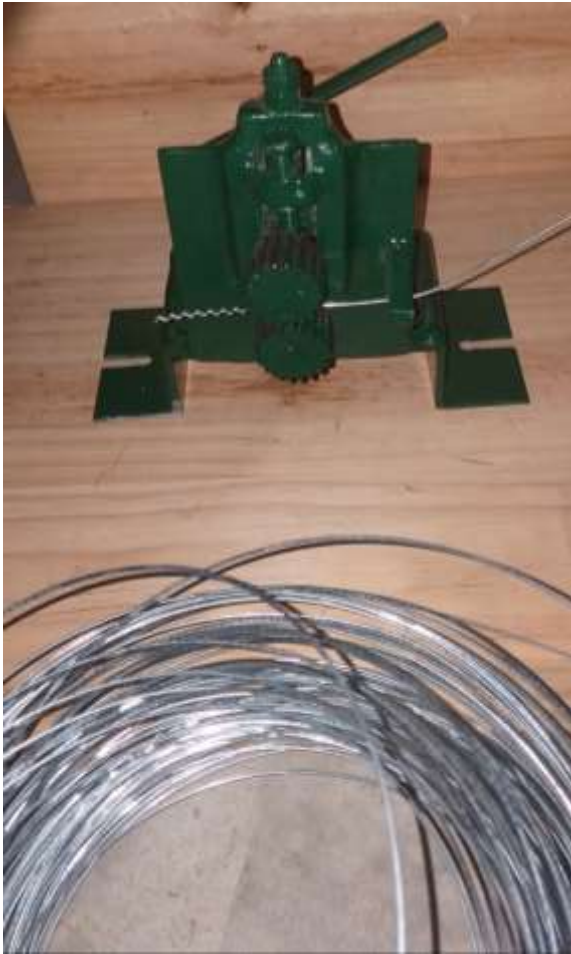
Figura 30: Producción de fibras onduladas de acero galvanizado
