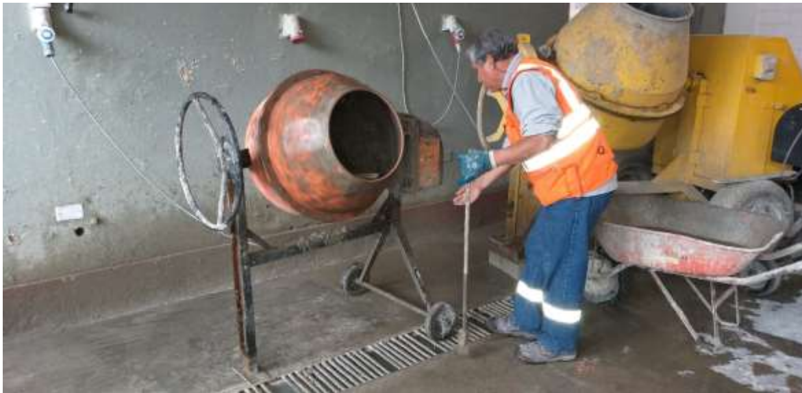
Figura 34: Preparación de la primera tanda de concreto con volumen de 0.015, (técnico Montes), laboratorio de ensayo de materiales (LEM-FIC-UNI)
