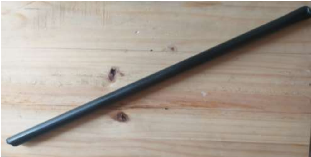
Figura 21: Palanca tubular metálica de 50 cm de largo con un diámetro exterior de \frac{3}{4} de pulgada, (extensión de palanca)
