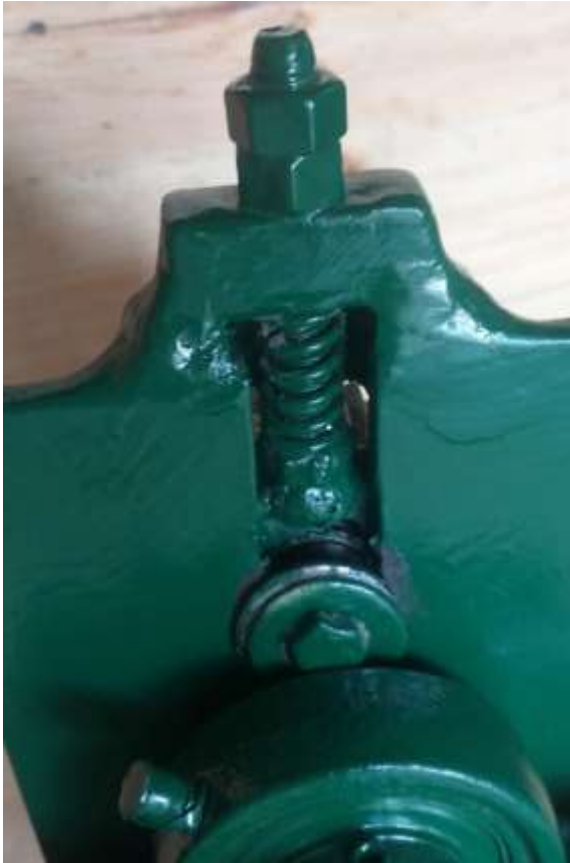
Figura 19: Dispositivo para fabricar fibras onduladas – 1er perno regulador
