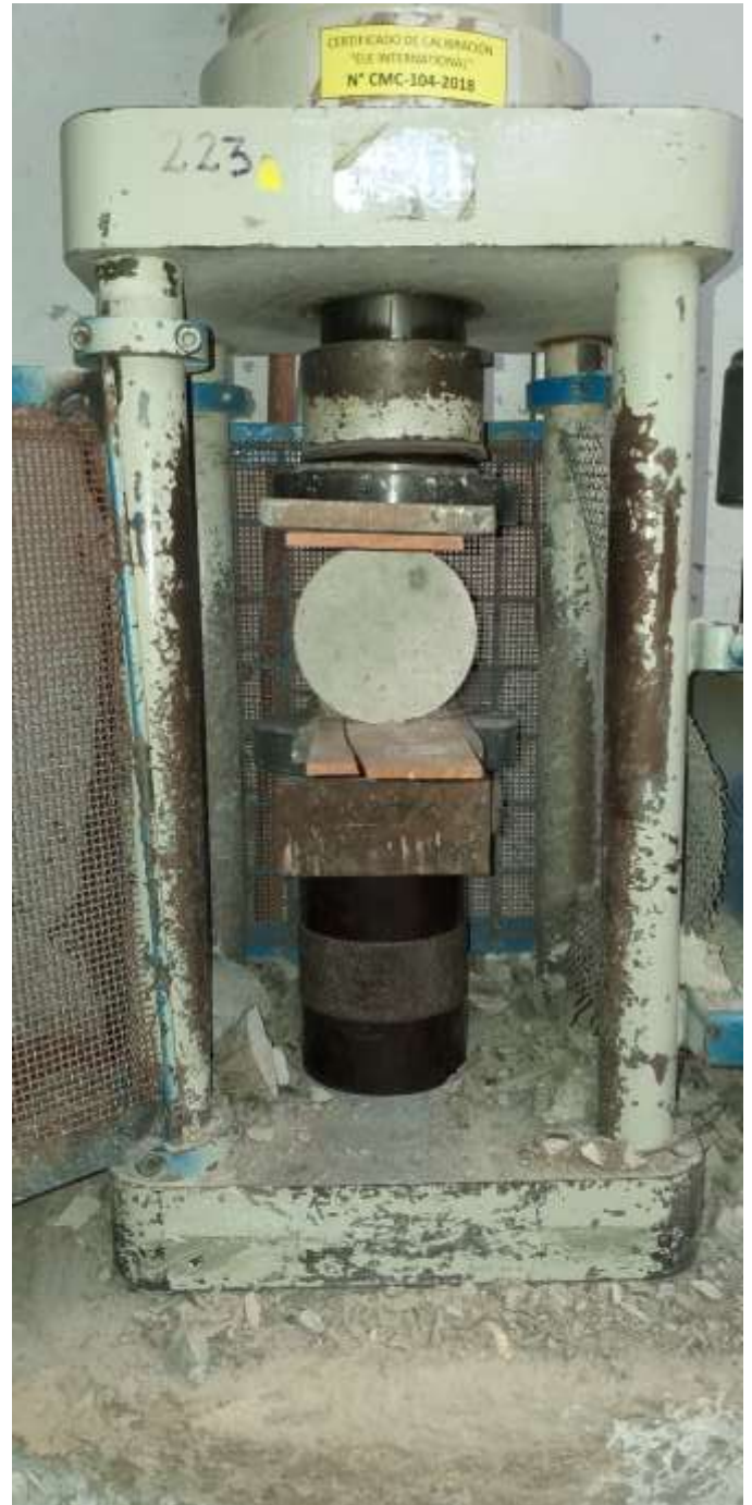
Descripción: Ensayo de resistencia a compresión diametral de probetas cilíndricas laboratorio (LEM)(UNI) ensayo de tracción.
