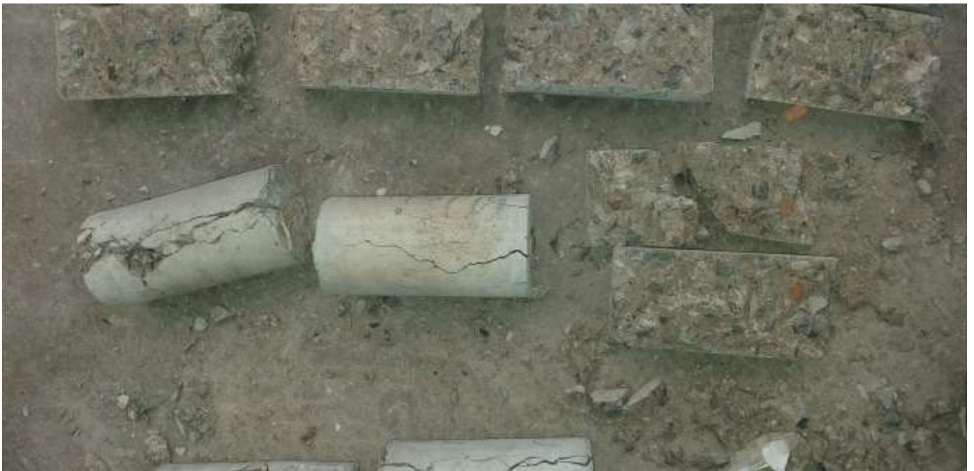
Descripción: Probetas cilíndricas después de rotura, ensayo de tracción, laboratorio (LEM)(UNI)
