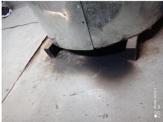
*Figura N°9: Quemadura del piso por fuga de vapores en el caldero*
