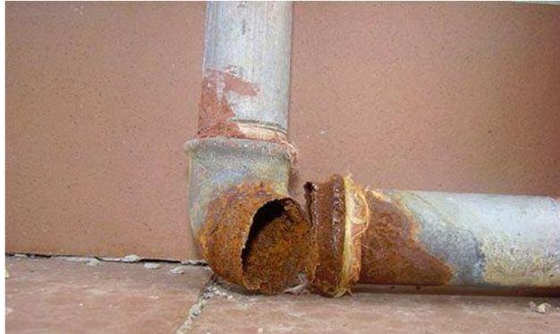
*Figura N°14: Corrosión de tuberías del caldero*
