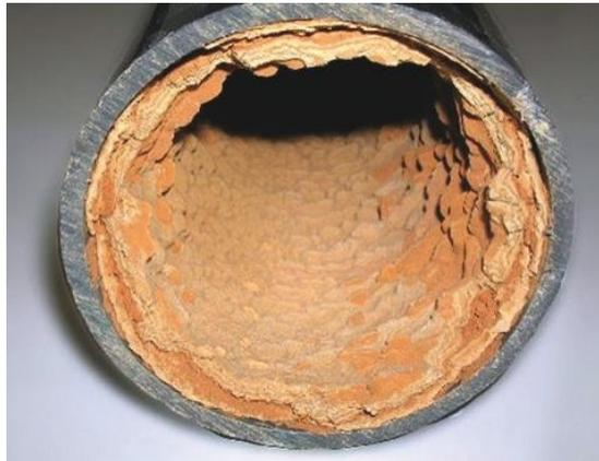
*Figura N°13: Incrustaciones en tubería.*
