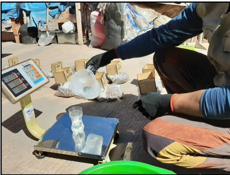
*Figura 46.* Proporciones de cada material con balanza electrónica.
