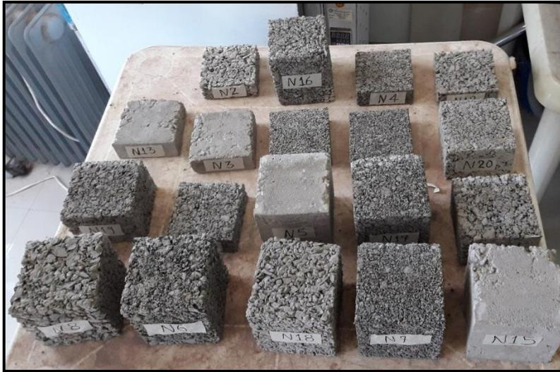
*Figura 53.* Muestras para en el ensayo a absorción y aislamiento de sonido
