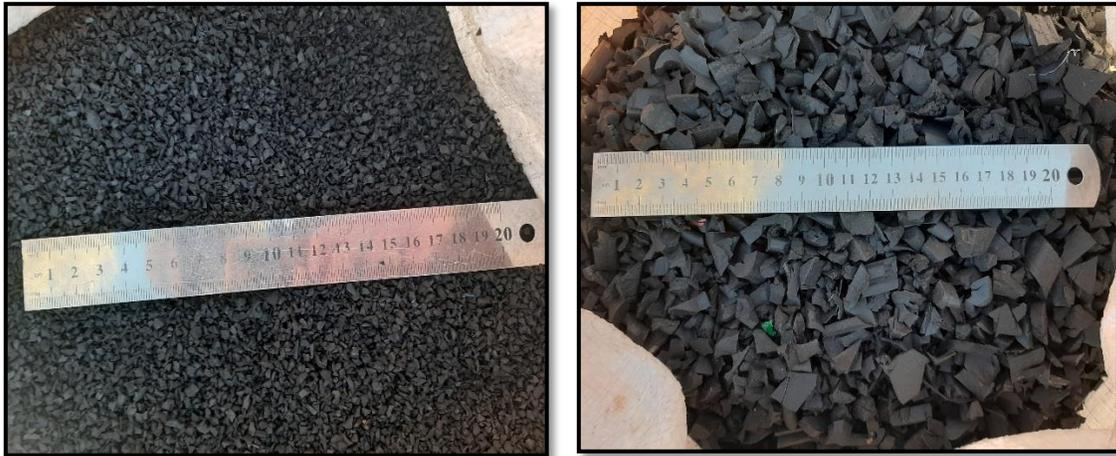
*Figura 5. Partículas de caucho por trituración mecánica*
