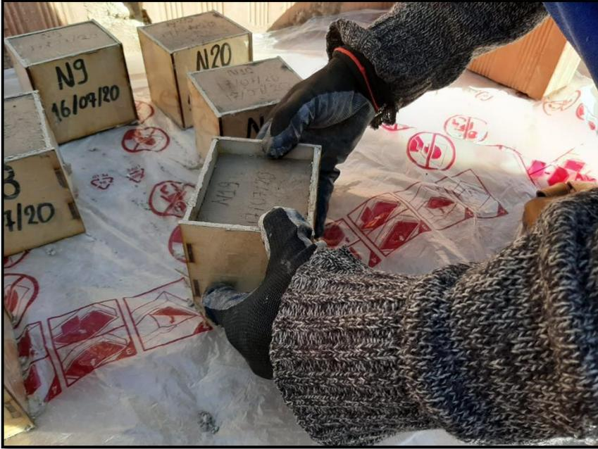
*Figura 11. Desencofrado de las muestras*
