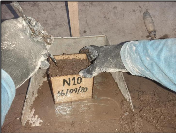
*Figura 10.* Colocación de la mezcla en los moldes hechos en mdf
