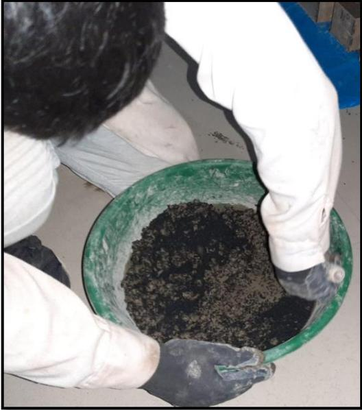
*Figura 49.* El mezclado de los agregados incluido las proporciones de caucho
