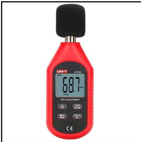
Figura 21. Sonómetro utilizado en el ensayo.
