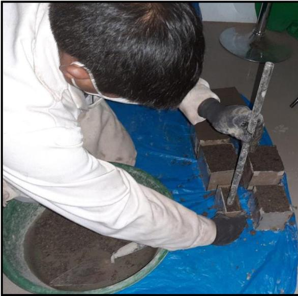
*Figura 50.* Colocación de la mezcla en cada molde según dosificación
