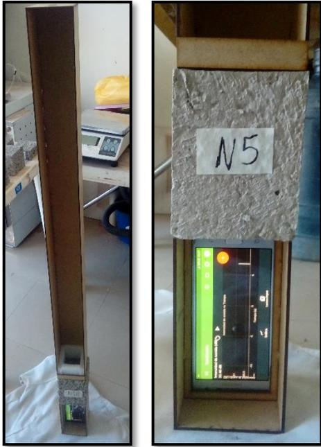
*Figura 14.* Prototipo de ensayo y la aplicación Sound level meter
