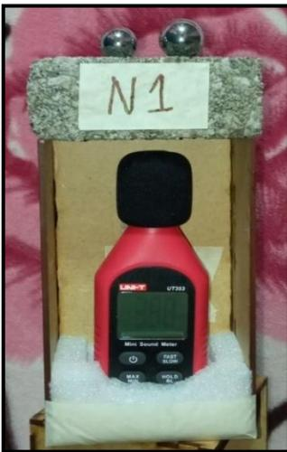
*Figura 27.* Base del prototipo, sonómetro, muestra N1 y villas de acero.
