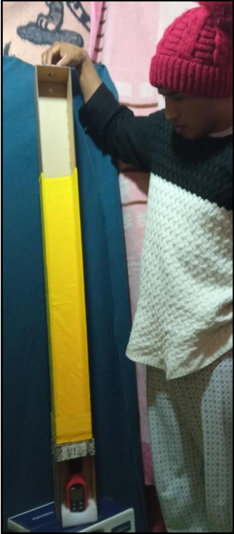
*Figura 59.* Ensayo de absorción y aislamiento de sonido en las muestras.
