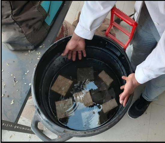
*Figura 26.* Curado de las placas o testigos.
