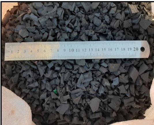
*Figura 19.* Adquisición de caucho granulado de 10mm a 15 mm.
