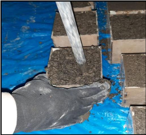
*Figura 25.* Disposición de la mezcla en los moldes tipo placa.
