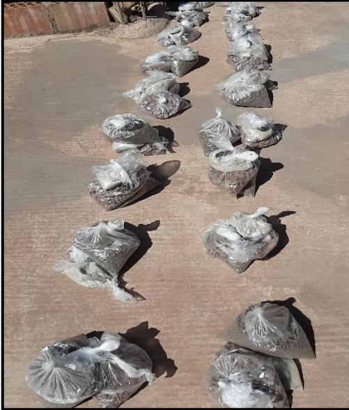
*Figura 8.* Peso de agregados sueltos (piedra, arena y caucho)
