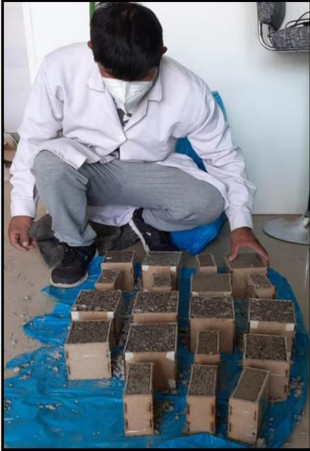
*Figura 51.* Fraguado de muestras por 24 horas.
