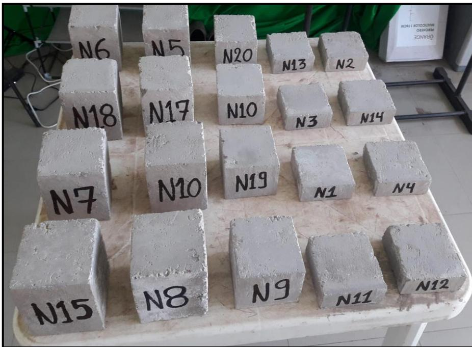
*Figura 13.* Muestras marcadas para la identificación
