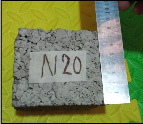
*Figura 55.* Dimensionamiento de las muestras con regla milimétrica
