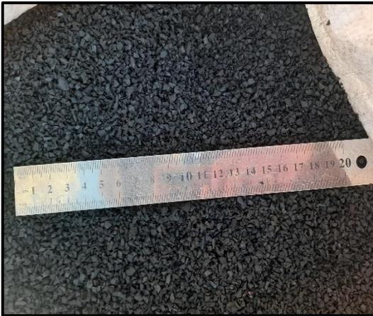
Figura 20. Adquisición de caucho triturado de 2mm a 5mm.
