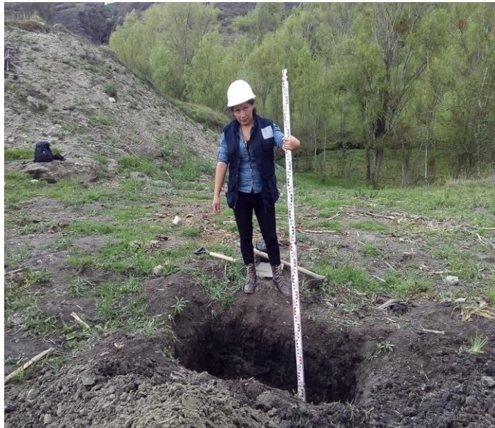
Figura N° 3: Calicata realizada en el reservorio.
