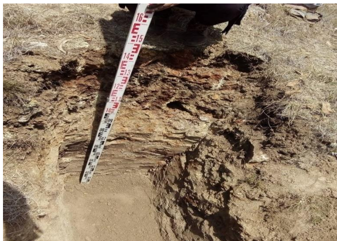
Figura N° 2: Calicata realizada en la Línea de Conducción.
