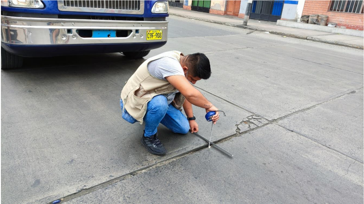
Imagen N° 07: Tomando medidas de la Escala que hay entre paños en el Tramo 2 de la Av. Aviación Cuadra 3
