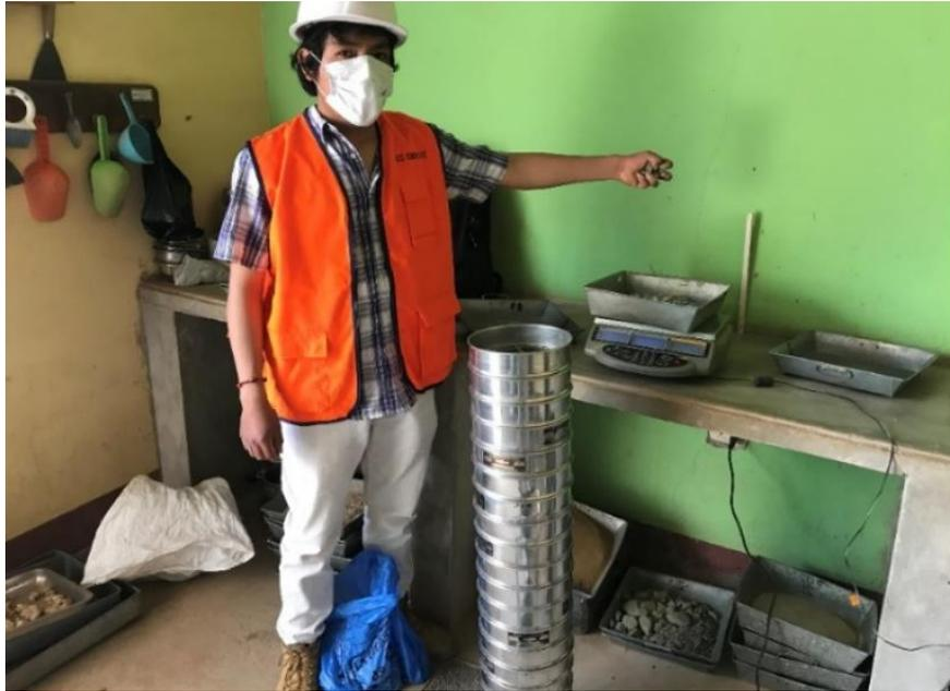
*Figura 30. Ensayo granulométrico (Peso de agregados)*
