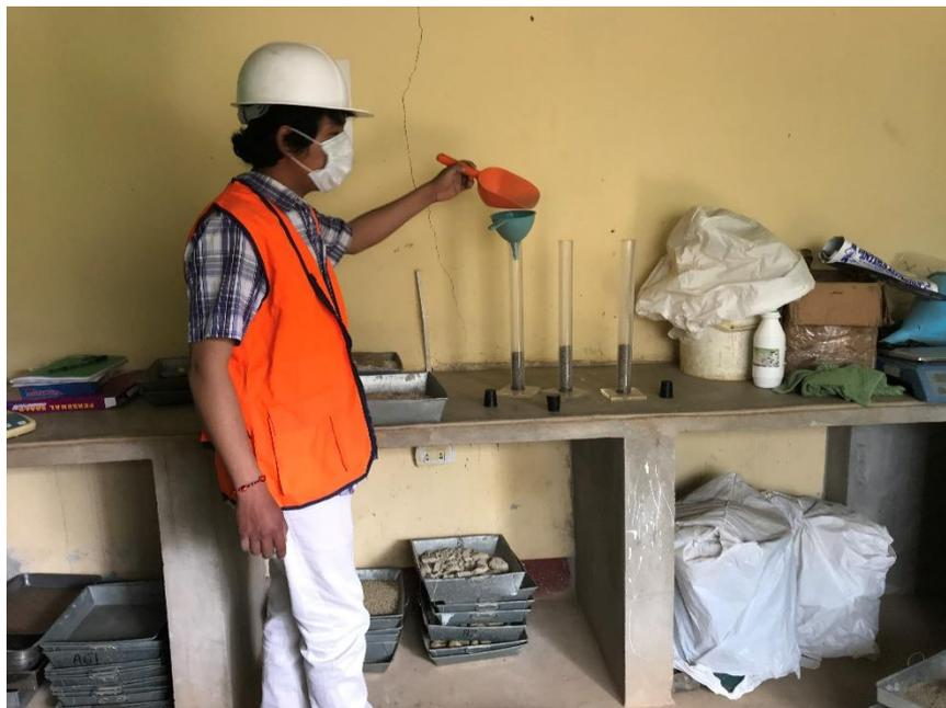
*Figura 33. Asentamiento del agregado fino*
