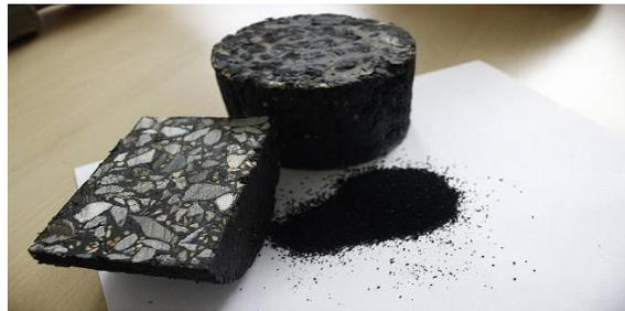
*Figura 10.* Muestreo de mezcla asfáltica con caucho reciclado.
