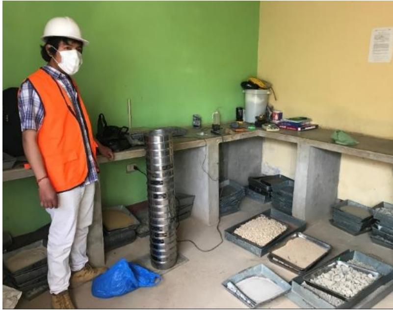
*Figura 34. Secado de materiales (salida de horno)*
