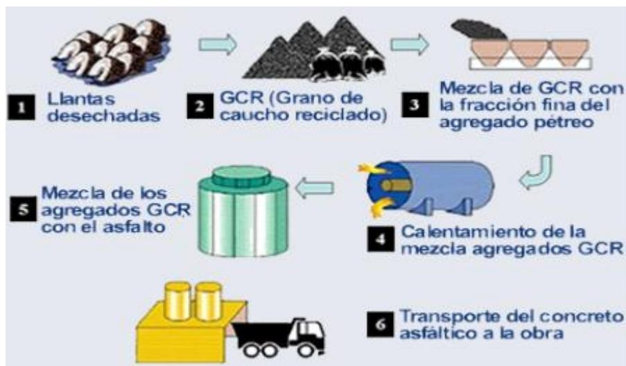
Figura 5. Proceso de fabricación de la mezcla asfalto – caucho (vía seca)
