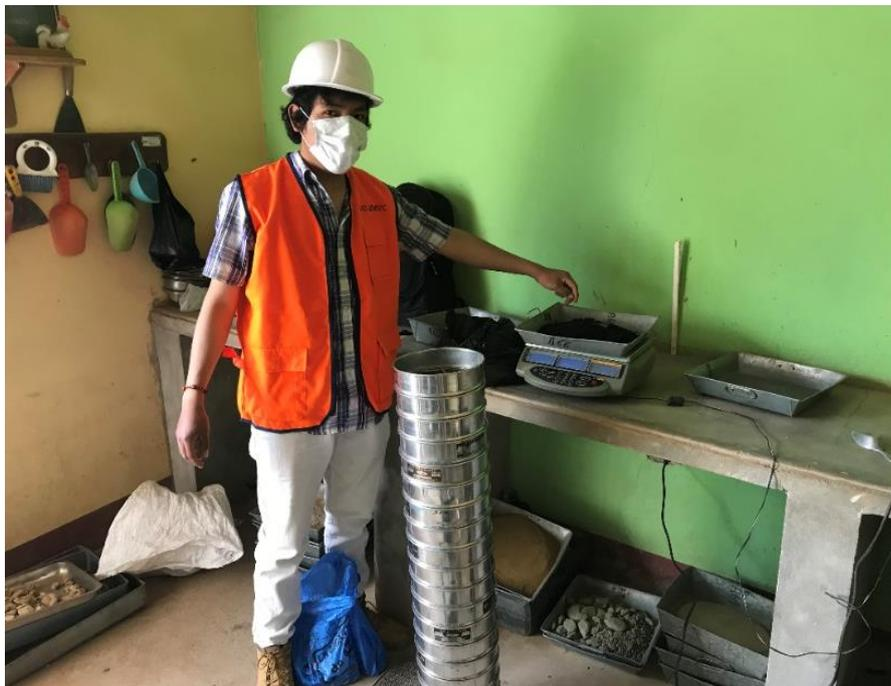
*Figura 31. Ensayo granulométrico (Peso de caucho)*
