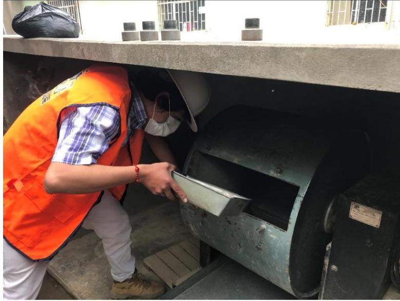
*Figura 32. Ensayo de abrasión los Ángeles.*
