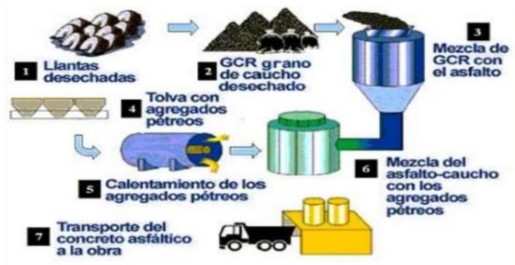
Figura 6. Proceso de fabricación de la mezcla asfalto – caucho (vía húmeda)
