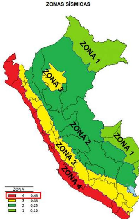
Figura 19 – FACTOR DE ZONIFICACION SISMICA – RNE E030
