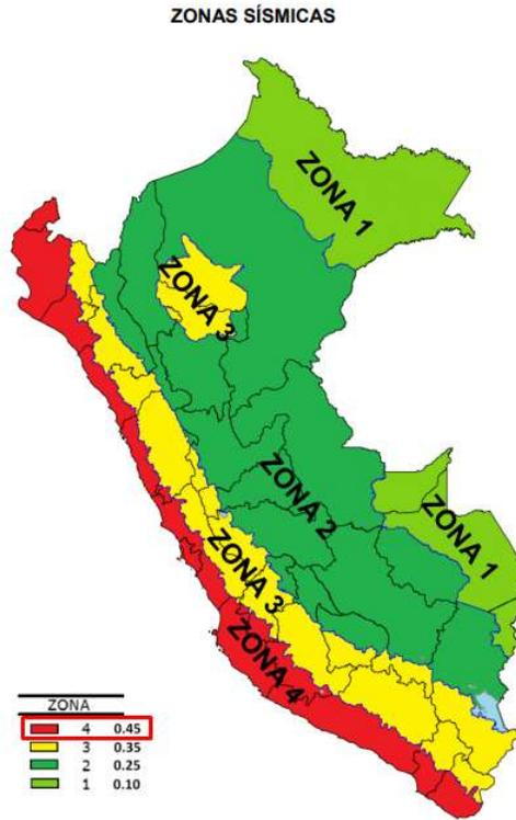
Figura 24 – FACTOR DE ZONIFICACION SISMICA – RNE E030
