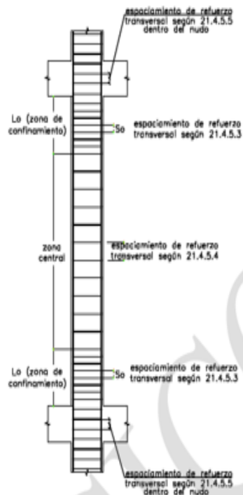
Fig. 21.4.5 Requerimientos de estribos en columnas
