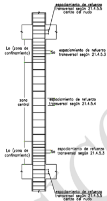
Fig. 21.4.5 Requerimientos de estribos en columnas
