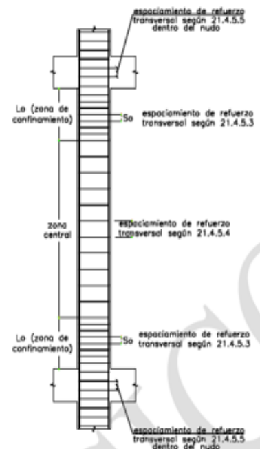
Fig. 21.4.5 Requerimientos de estribos en columnas
