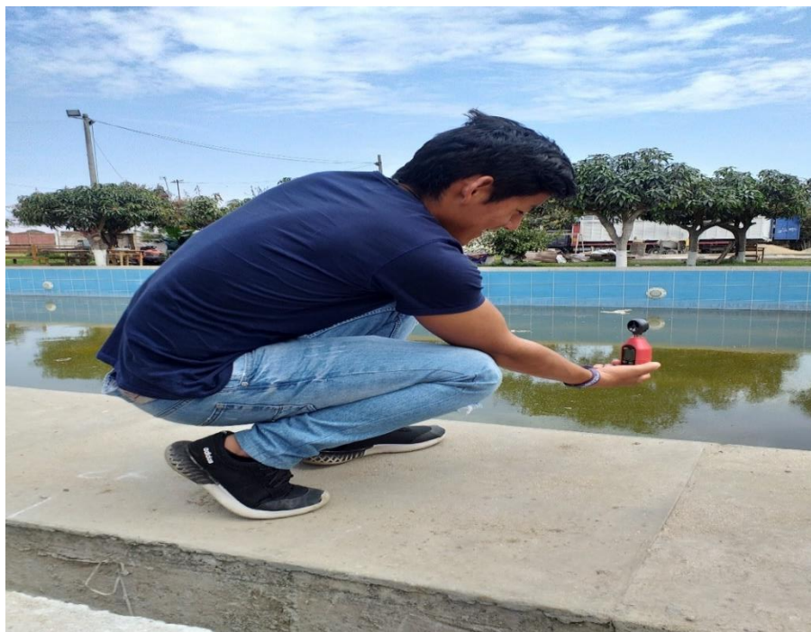
Anexo N°25: Toma de medición de velocidad del viento con anemómetro en la superficie de piscina
