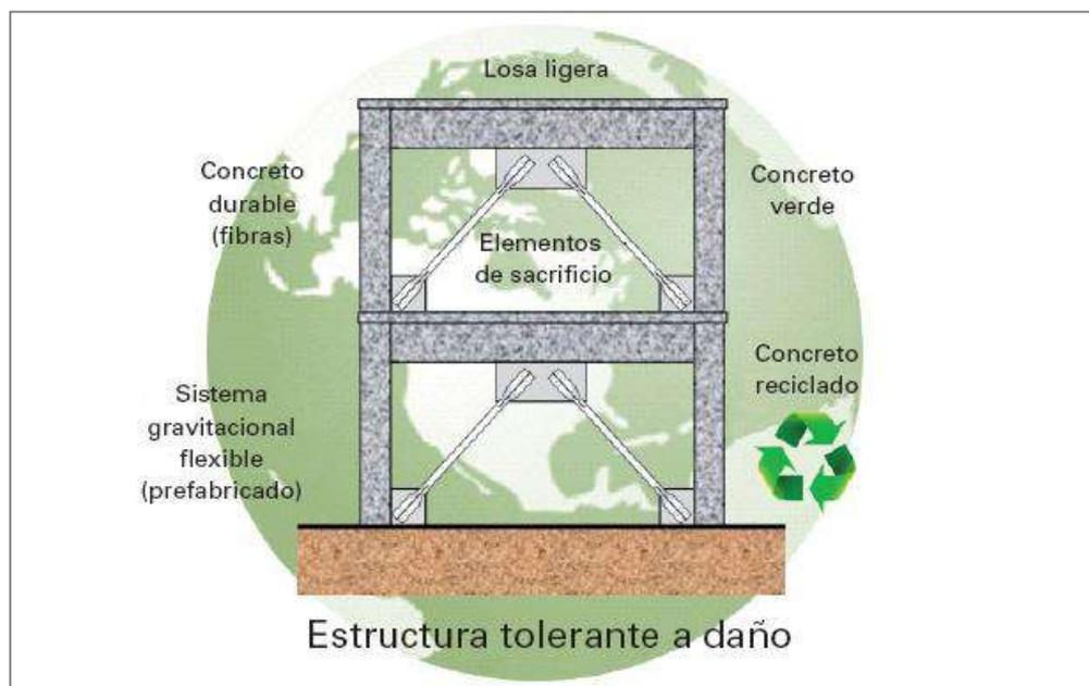
Figura 18. Sistema estructural sismorresistente de concreto reforzado para una edificación verde. Recuperado de: [http://www.scielo.org.mx/scielo.php?script=sci\\_arttext&pid=S2007-30112010000100001](http://www.scielo.org.mx/scielo.php?script=sci_arttext&pid=S2007-30112010000100001)
