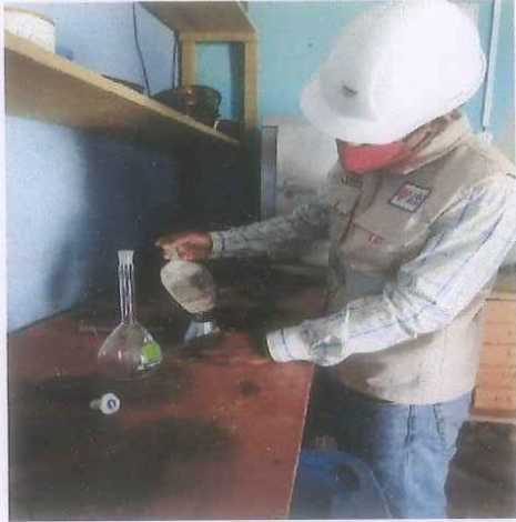
Fotos nº 09-10: En las imágenes podemos observar la realización del ensayo de peso específico.
