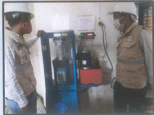
Fotos nº 11-12: En las imágenes podemos observar la resistencia a la compresión axial de los testigos de concreto
