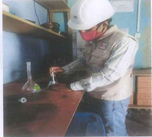
Fotos nº 09-10: En las imágenes podemos observar la realización del ensayo de peso específico.
