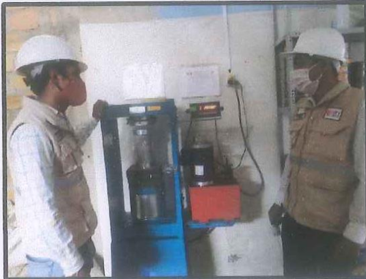
Fotos nº 11-12: En las imágenes podemos observar la resistencia a la compresión axial de los testigos de concreto
