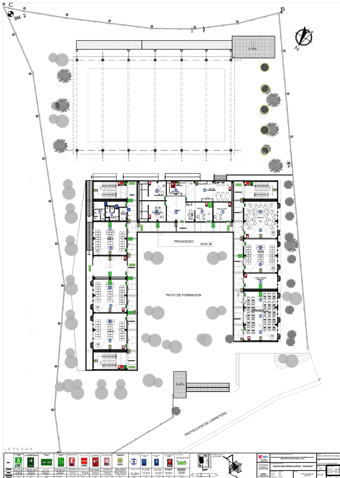
Figura 60 Plano de señalización en segundo nivel
