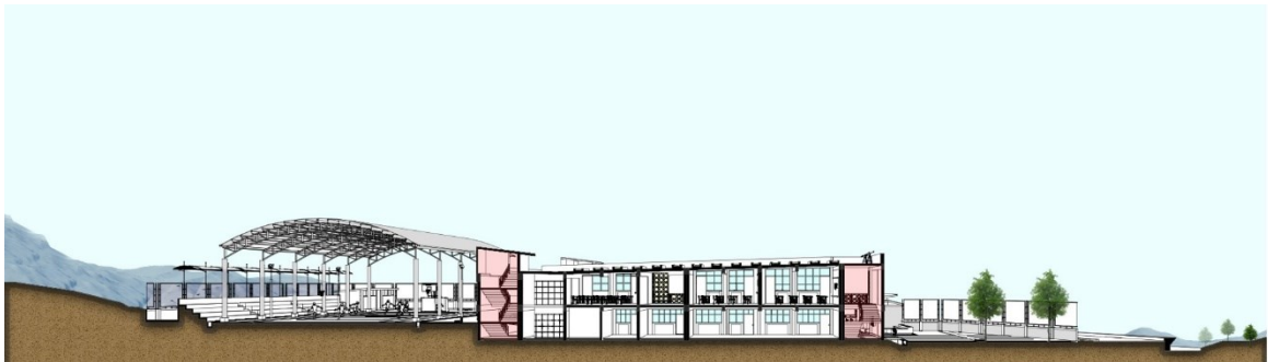
Figura 24 Adaptación al terreno
