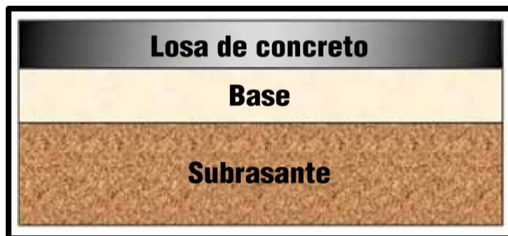
Figura 2: Estructura de un pavimento rígido
