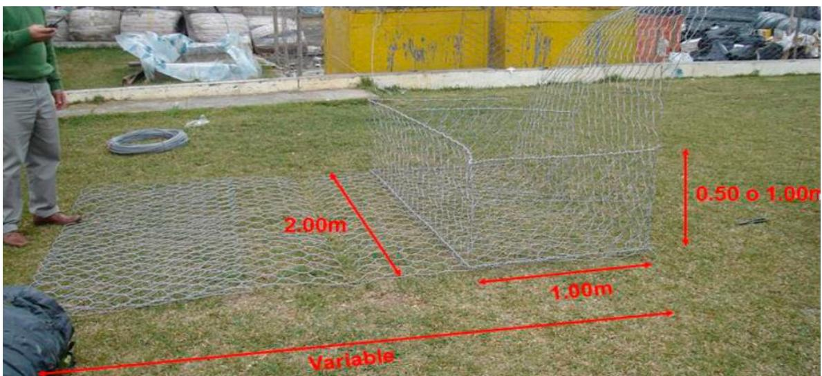
**Figura 6.** Elemento sistema Terramesh.
