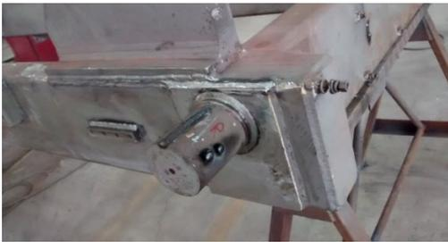
*Figura 8.* reparación de fisuras encontradas por método NDT.
