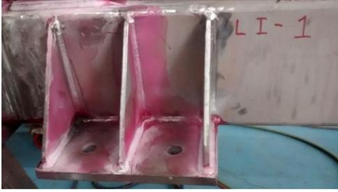
*Figura 15.* aplicación de tintes penetrantes a zonas reparadas de subframe (NDT ensayos no destructivos)
