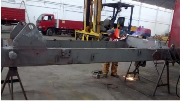
Figura 6. de reparación de fisuras observadas según informe del cliente.
