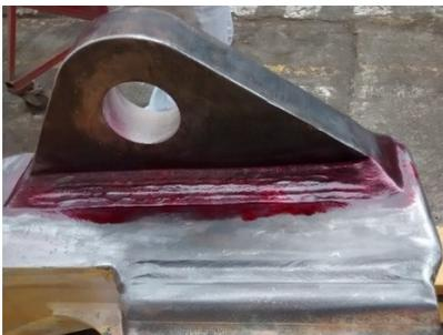
*Figura 13.* aplicación de tintes penetrantes a alojamientos barrenados de subframe (NDT ensayos nos destructivos)
