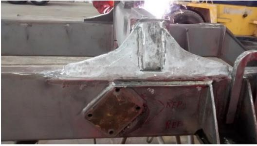
*Figura 7.* reparación de fisuras observadas según informe del cliente.
