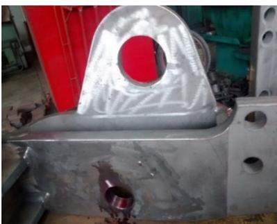
*Figura 14.* aplicación de tintes penetrantes a alojamientos maquinados de cratles
