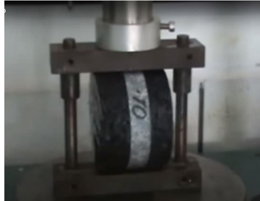
Ensayo de resistencia a compresión diametral
