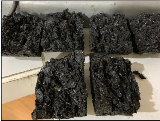
Muestras luego del ensayo Marshall
