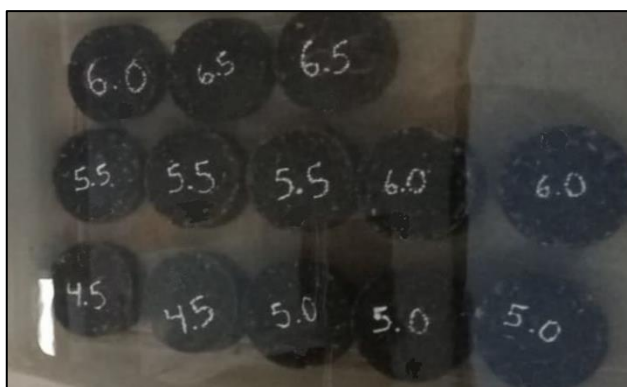
Figura 5. Probetas con mezcla asfáltica convencional.
