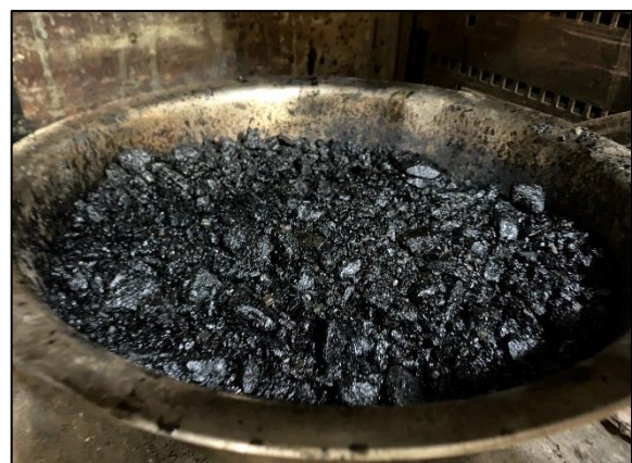
Figura 16. Mezcla uniformizada de agregados, polímeros y cemento asfáltico.
