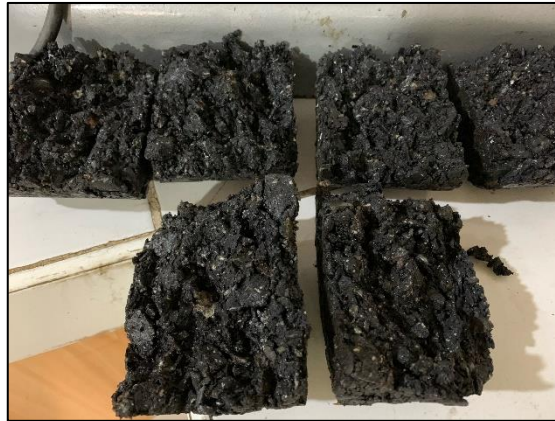
Figura 19. Probetas luego del ensayo Marshall.
