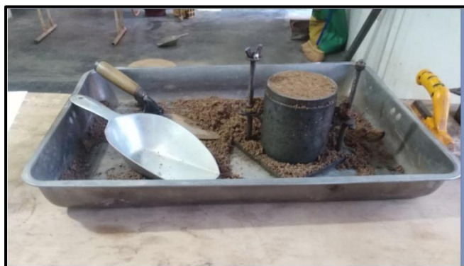
Foto 07 - Compactación Proctor estándar
