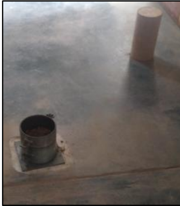
Foto 08 - Moldes a usar en el ensayo de CBR
