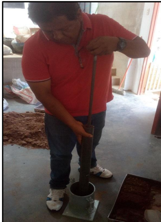
Foto 11 - Compactación de la muestra con humedad controlada en el molde
