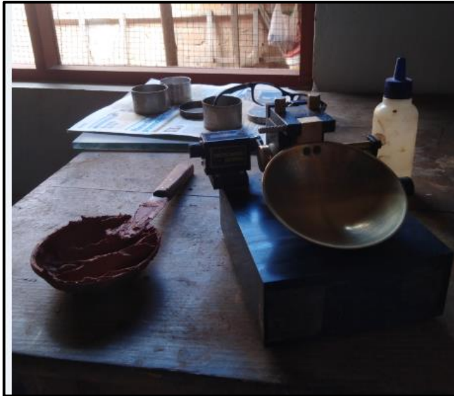
Foto 05 - Determinación del límite líquido de un suelo por el método de copa de Casagrande
