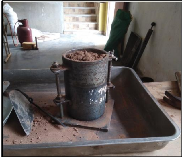
Foto 10 - Enrazado del molde de la compactación.
