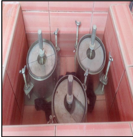
Foto 12 - Introduciendo los moldes CBR con muestras compactadas en la posa de agua
