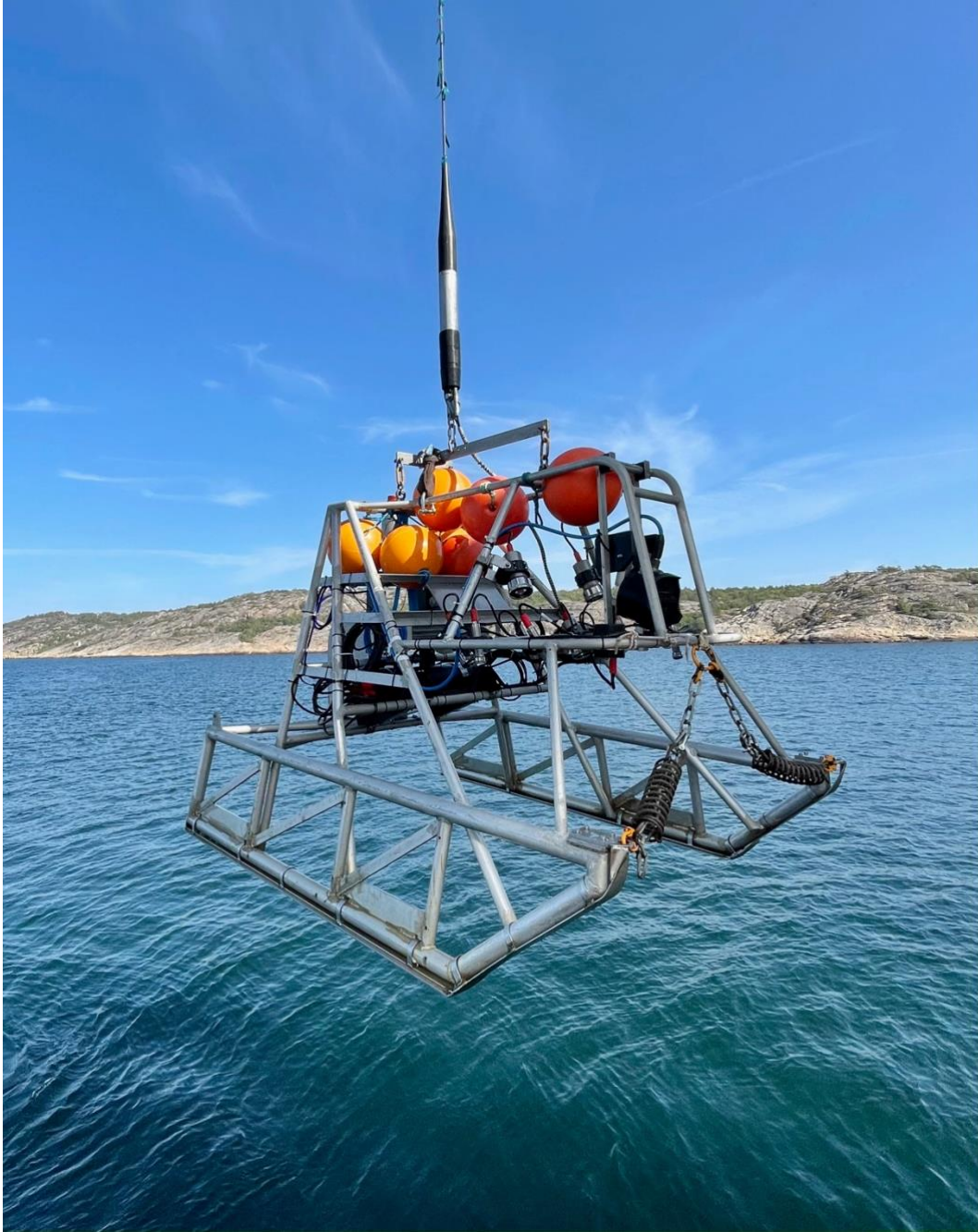
Figur 4. UWTV:n som drop-video redo för sjösättning på Lilla Middelgrund. En flöjel är monterad i bakkant som håller UWTV:n riktad mot strömmen när den förs fram över botten hängandes bakom fartyget.
