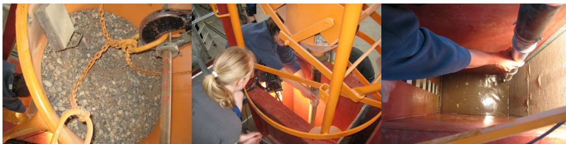
Bild 3.12 Versuchsoptimierte Einbautechnik nach der Darmstädter Einrieselungsmethode
