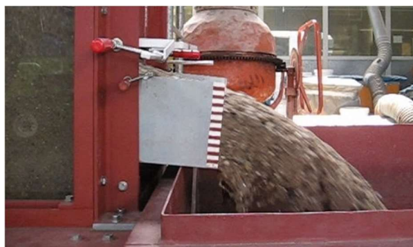
Bild 3.25 Ausfließen des wassergesättigten Bodens aus dem Versuchstand
