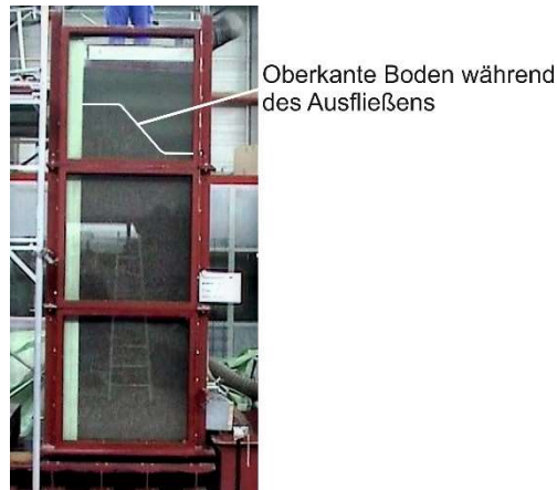
Bild 3.26 Schiefstellung des wassergesättigten Bodens während des Fließprozesses
