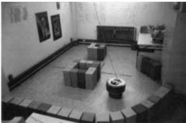
Bild 8: Reale Experimentierumgebung mit zwei Hindernissen. Vorlernen mit einem Hindernis verkürzt das Lernen für die neue Aufgabe auf das Erlernen des Durchfahrens zwischen den Hindernissen [9].
