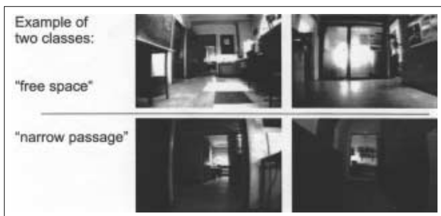
Bild 13: Ergebnis einer weiteren Klassifikation: Die interne Einteilung der Bilder aus einer Büroumgebung in zwei Klassen entspricht einer möglichen menschlichen Einteilung in „Freiraum“ und „Engstelle“ ([18]).
