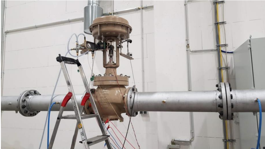
Abbildung A-17: Realer Messaufbau mit Messsystem „dSPACE“
