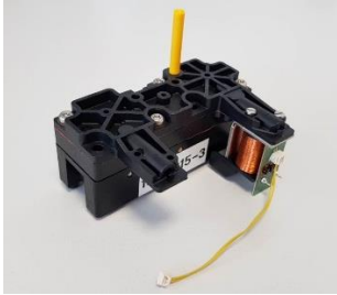
Abbildung 2-23: Luftleistungsverstärker im Stellungsregler
