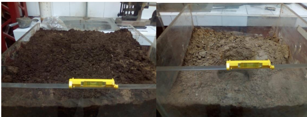
Figura 3.18. Nivelación horizontal de las muestras
