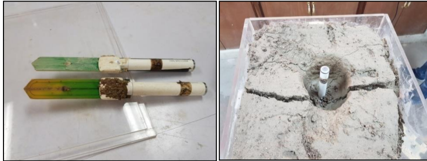
Figura 3.28. Sensores TMS3 colocados en las muestras de TBJ.
