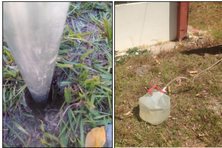
Figura 4.6. Exvacion del agujero de 6 cm de diametro y llenado del recipiente con agua.
