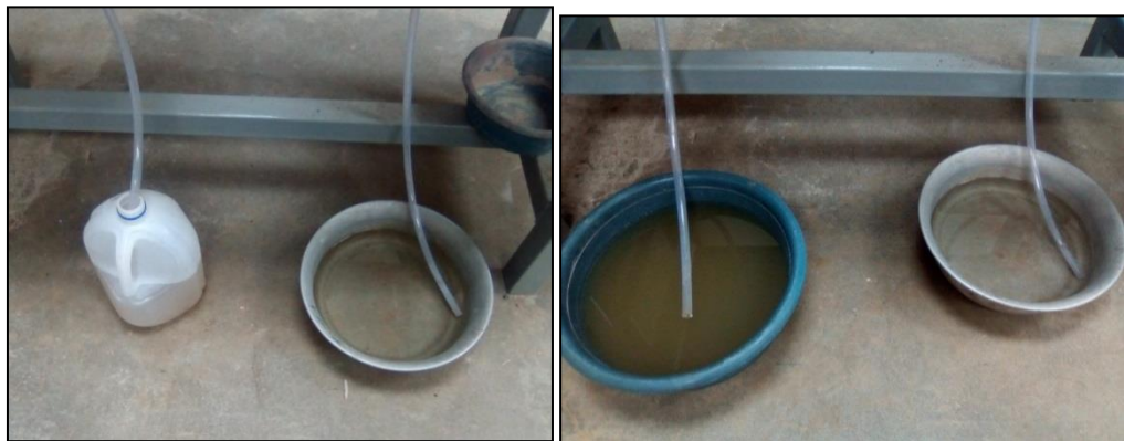
Figura 3.21. Mangueras instaladas para evacuar el agua excedente de las muestras
