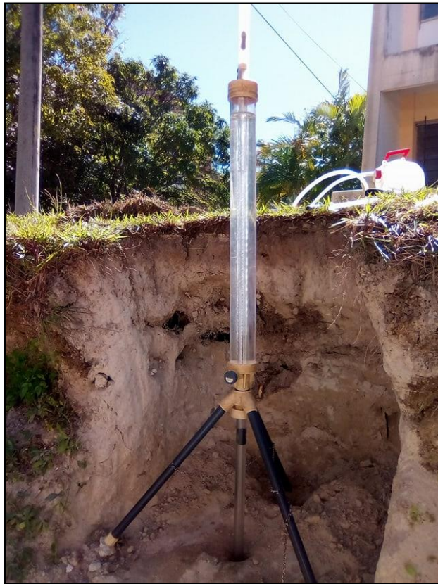
Figura 4.10. Permeámetro de Guelph instalado en campo.
