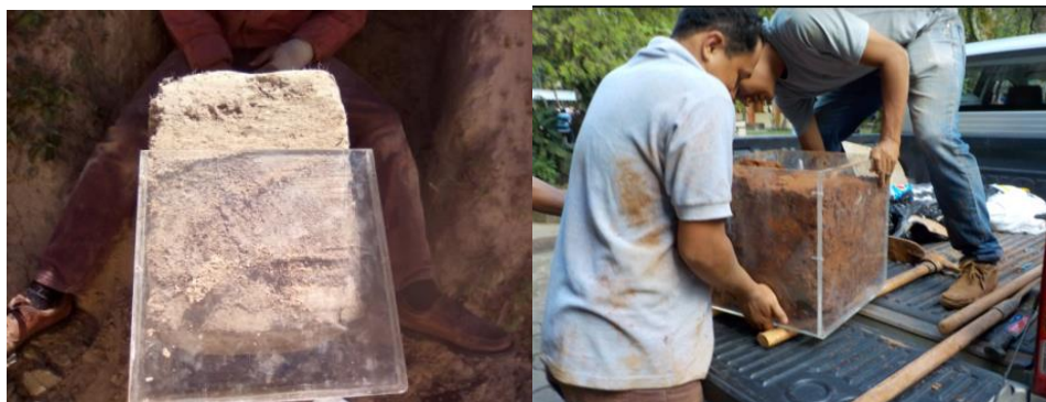
Figura 3.16. Muestra dentro de caja de acrílico para su posterior transporte hacia el laboratorio de suelos y materiales.
