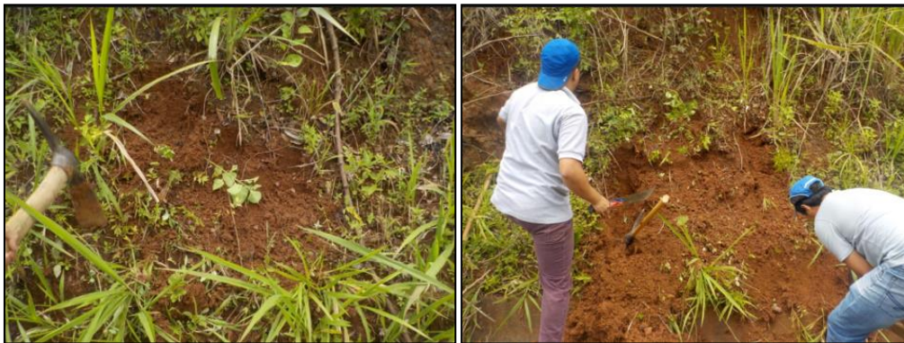
Figura 3.12. Limpieza de area de talud para la extraccion de muestra
