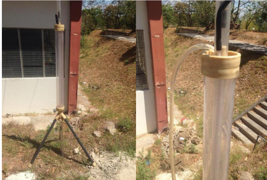
Figura 4.7. Montaje del quipo y llenado de ambos tubos.
