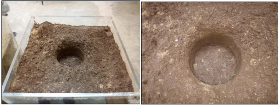
Figura 3.19. Agujero excavado para prueba de infiltración.
