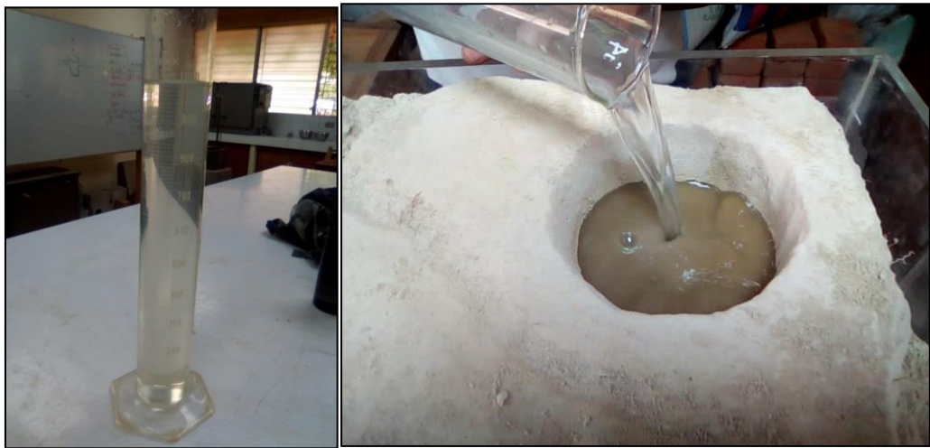
Figura 3.20. Llenado de agua en los agujeros para el proceso de infiltración.
