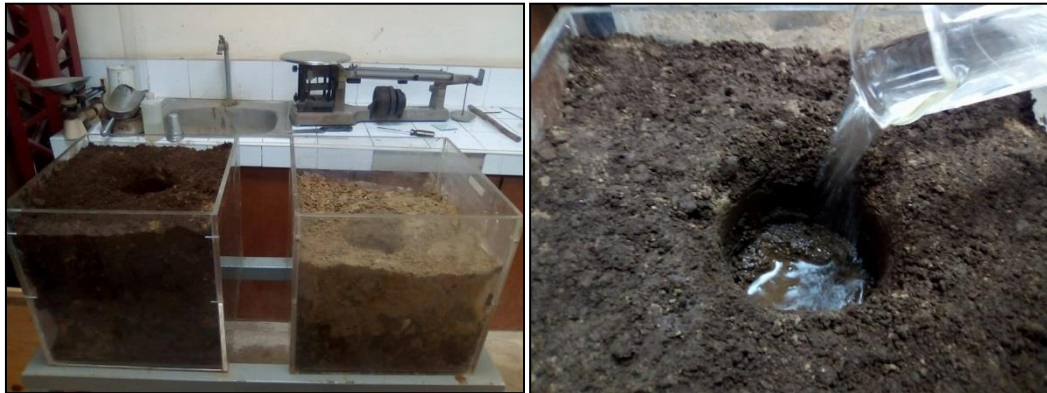
Figura 3.9. Muestra de suelos llevadas a laboratorio y colocadas en las cajas de acrílico y colocación de carga hidráulica controlada.
