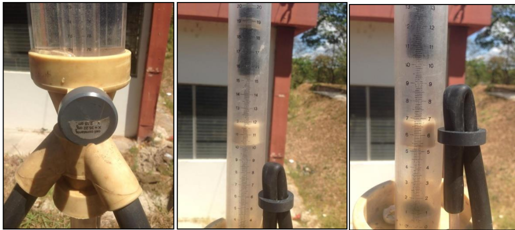
Figura 4.4. Válvula de control para llenar reservorio, medidor de carga o tubo Marriotte superior.
