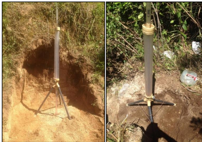
Figura 4.11. Medición de la permeabilidad En la izquierda suelo TB4 y a la derecha flujo de escombros cantón el Carmen.
