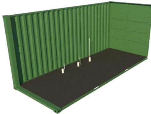
Luego de instalar los accesorios para la plomería, se debe colocar una capa aislante de caucho de etileno-polietileno-dieno monómero comúnmente conocido comercialmente EPDM. El cual tiene excelentes propiedades para impedir el paso de humedad y agentes externos que puedan dañar la madera base del contenedor.
