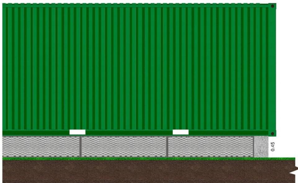
**Figura.14** Ejemplo de Cerramiento Inferior por Elevación del Contenedor
