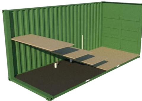
Sobre esta capa de aislante se debe reinstalar la madera original del contenedor, esta servirá de base rígida para la instalación posterior del acabado final de piso. Con la única restricción que alguna lamina o todas si fuera el caso estuvieran dañadas de manera irremediables, estas se deben remplazar por una pieza de igual resistencia.
