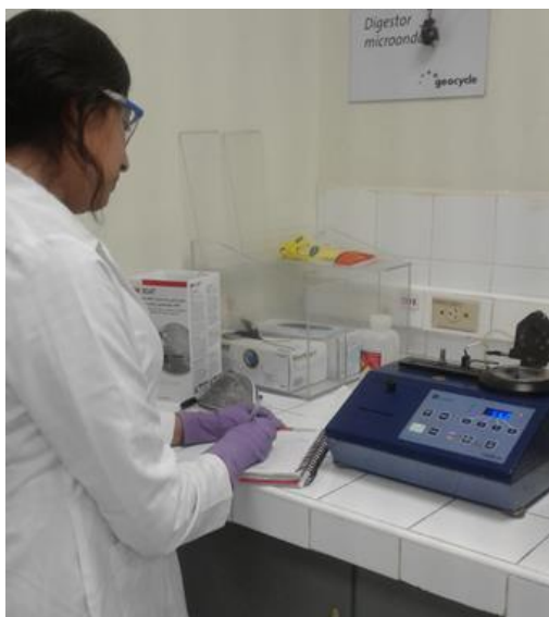
Figura 114. Prueba de determinación de Flash Point en copa cerrada
