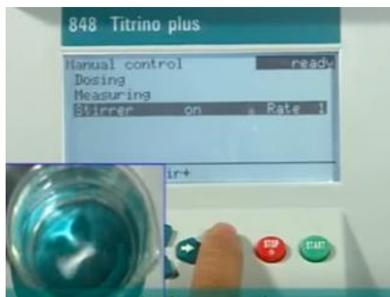
Figura 16. Titulador automático Titrino Plus, configuración y encendido de la agitación para la utilización del agitador magnético.
