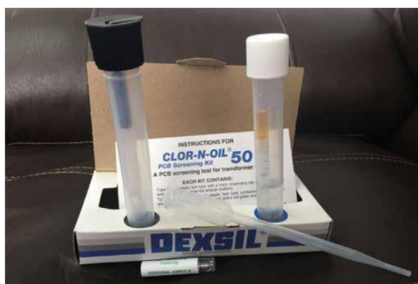
Figura 8. Kit Clor-N-Oil para determinación de presencia de bifenilos policlorados.
