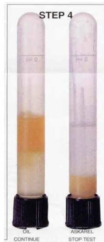
Figura 9. Izquierda tubo con aceite sobre la fase acuosa (se continúa la prueba), derecha tubo con aceite bajo la fase acuosa (se suspende prueba).
