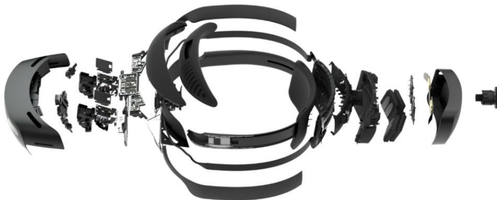
Abb. 9: HoloLens 2 Explosionsdarstellung [Mic20].
