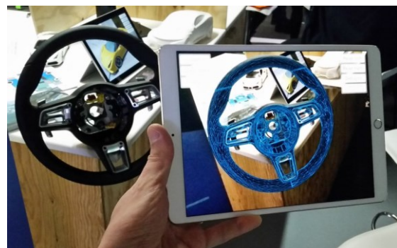
Abb. 15: Markerlose Objekterkennung mittels des VisionLib SDK's [Vis18].
