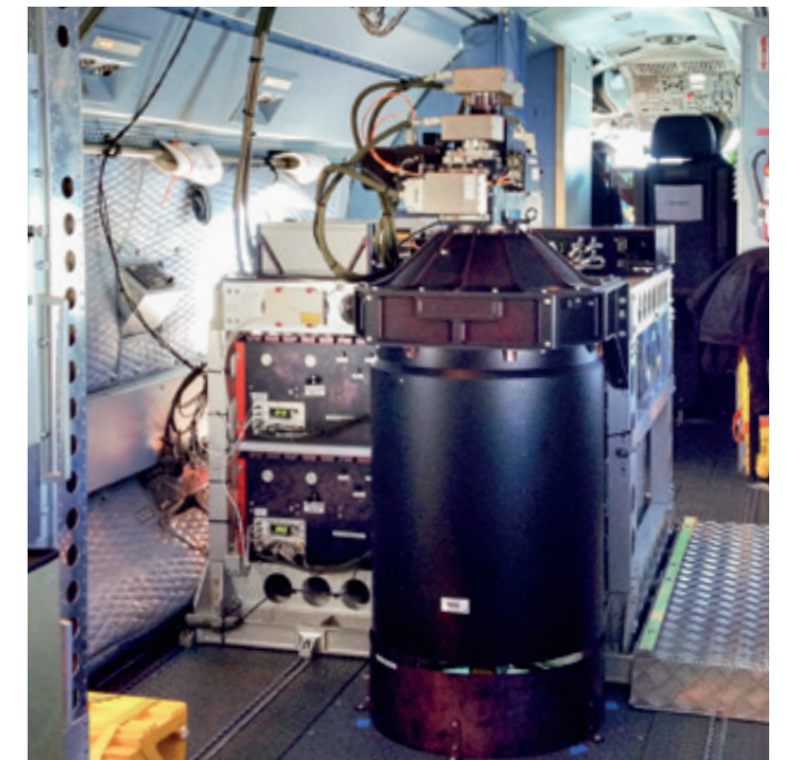
Das Aerosol- und Wasserdampf-Lidar des DLR-Instituts für Physik der Atmosphäre
