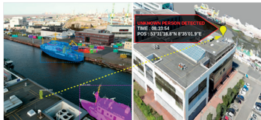
Dreidimensionales Echtzeitlagebild des Bremerhavener Hafens. Links: Kamerabild mit Objekten, die mittels künstlicher Intelligenz automatisch erkannt und entsprechend ihrer Form eingefärbt wurden. Rechts: vorläufiges 3D-Modell der Umgebung mit Angaben der Position einer Person, die sich in einem potenziell gefährlichen Bereich befindet.
