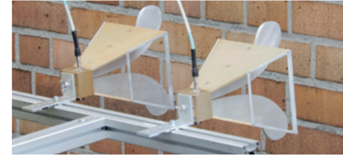
GTOM-Antennen durchleuchten eine Hauswand
