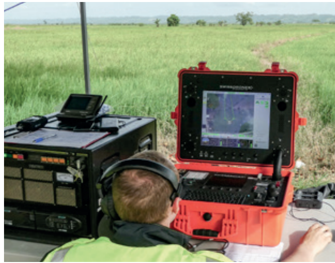
Humanitäre Mission in der Dominikanischen Republik: Im Juli 2018 führte das DLR-Institut für Flugsystemtechnik Flugversuche durch, um Hilfsgüter mit dem unbemannten Hubschrauber superARTIS (Autonomous Rotorcraft Testbed for Intelligent Systems) in schwer zu erreichende Gebiete zu transportieren. An der mobilen Bodenkontrollstation wurden die Flüge geplant und überwacht.
