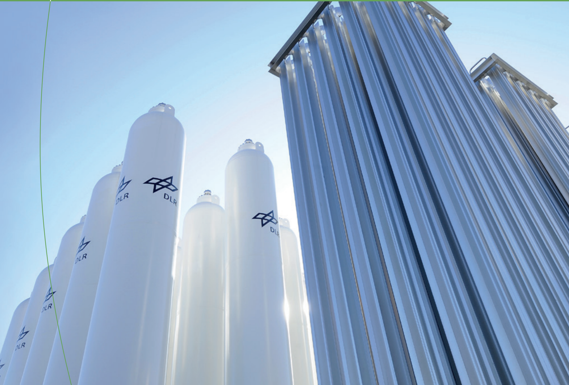
Diese Anlage zur Wasserstoffversorgung steht im DLR Köln. Das Institut für Antriebstechnik nutzt sie, um neue, sparsame und leistungsstarke Gasturbinen für Luftfahrt und Energietechnik zu entwickeln und zu testen.
