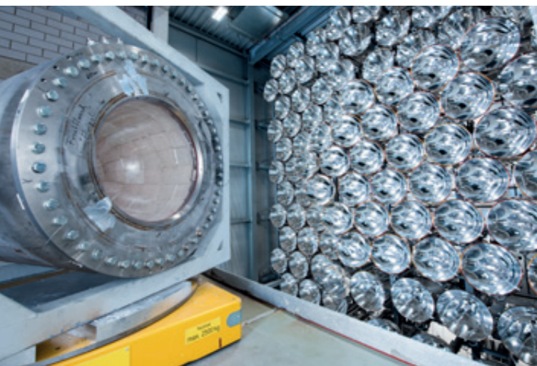
Reaktor zur thermischen Wasserstoffherzeugung mit Solarstrahlung im Hochleistungsstrahler Synlight des DLR Jülich
