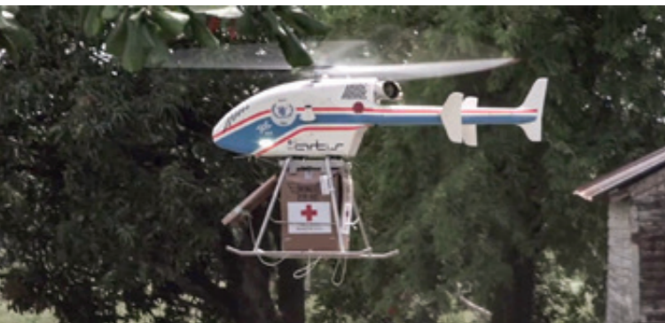
Der unbemannte Kleinhubschrauber superARTIS wird am Institut für Flugsystemtechnik als Experimentalträger betrieben. Dank seiner Reichweite, Robustheit und Nutzlastfähigkeit eignet er sich gut für humanitäre Einsätze.
