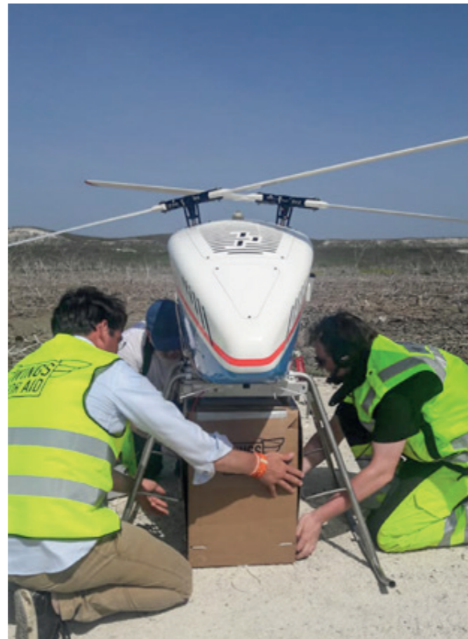
Bis zu 25 Kilogramm Nahrung, Wasser und Medikamente transportierte der unbemannte Hubschrauber sechs Kilometer weit über den Salzsee Enriquillo und warf die Nutzlastboxen sicher am anderen Ufer ab
