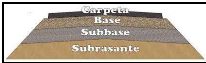
FIGURA 1. Capas de un pavimento flexible.
