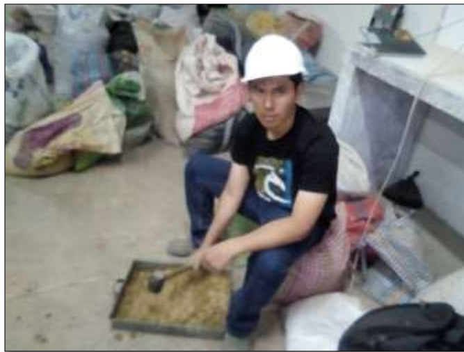
FIGURA 50. Preparación de la muestra patrón para el ensayo del CBR.
