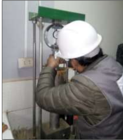
FIGURA 55. Prueba de penetración de las muestras saturadas.
