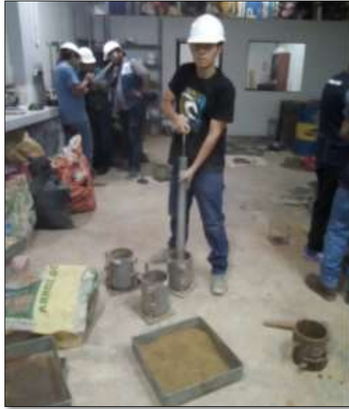
FIGURA 51. Ensayo de CBR de la muestra patrón con 12 golpes.
