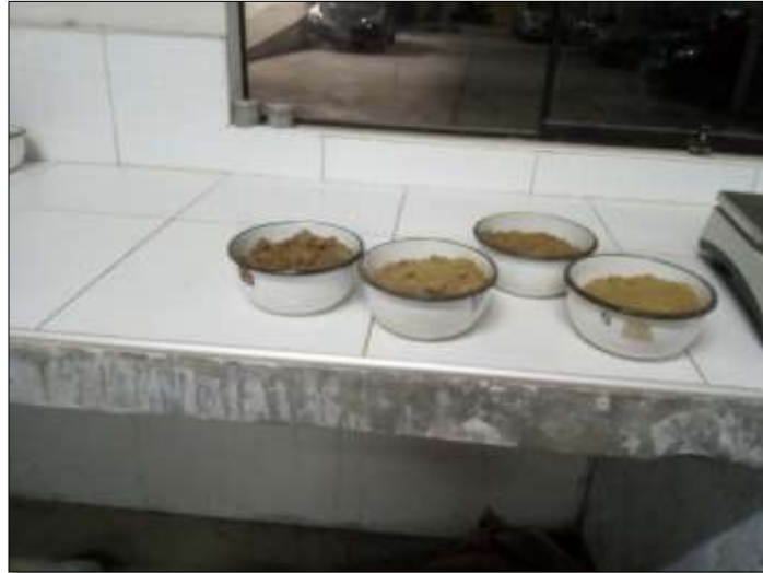
FIGURA 49. Ensayo para el contenido de humedad.
