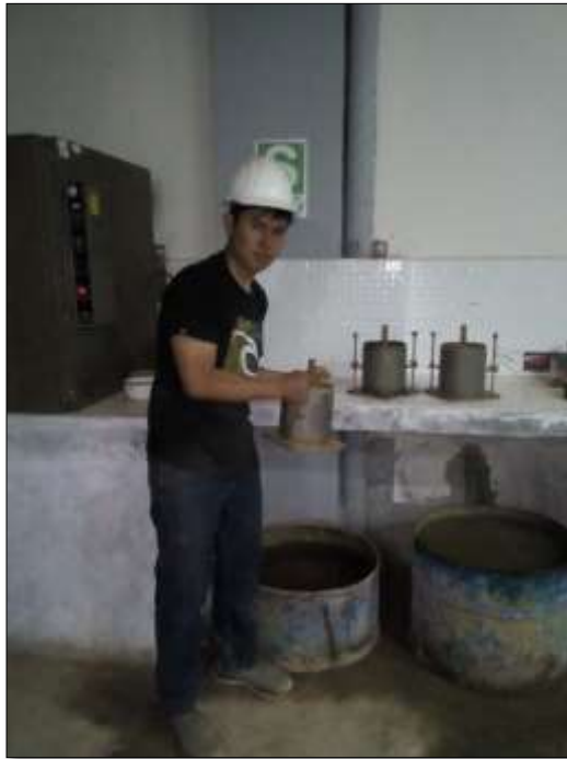
FIGURA 53. Etapa de saturación de las tres muestras patrón.
