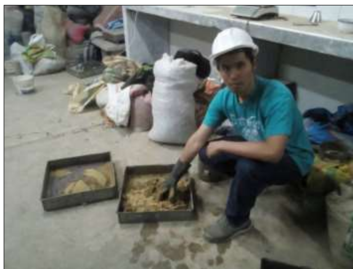
FIGURA 58: Mezcla de la muestra con 100 ml de aditivo para el análisis del CBR.
