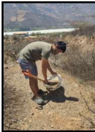
FIGURA 35. Extrayendo la muestra de la primera calicata.
