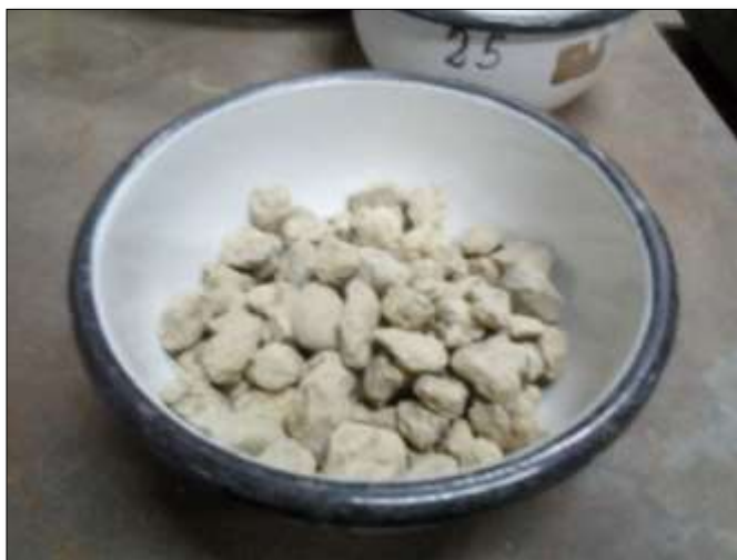
FIGURA 43. Muestra filtrada por la malla n° ½.
