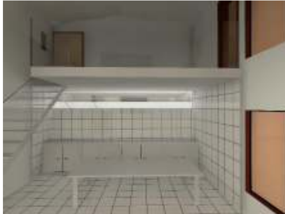
Fig. 72 - Cenário 3: vistas do interior reconstruído com ducto de luz e revestimento de gesso cartonado branco nas paredes e teto.
