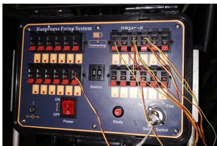
Figura 12. Recetor DB24r-X com ignitores ligados em alguns números
