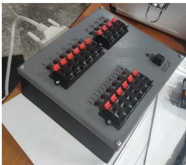
Figura 70. Régua de terminais concluída
