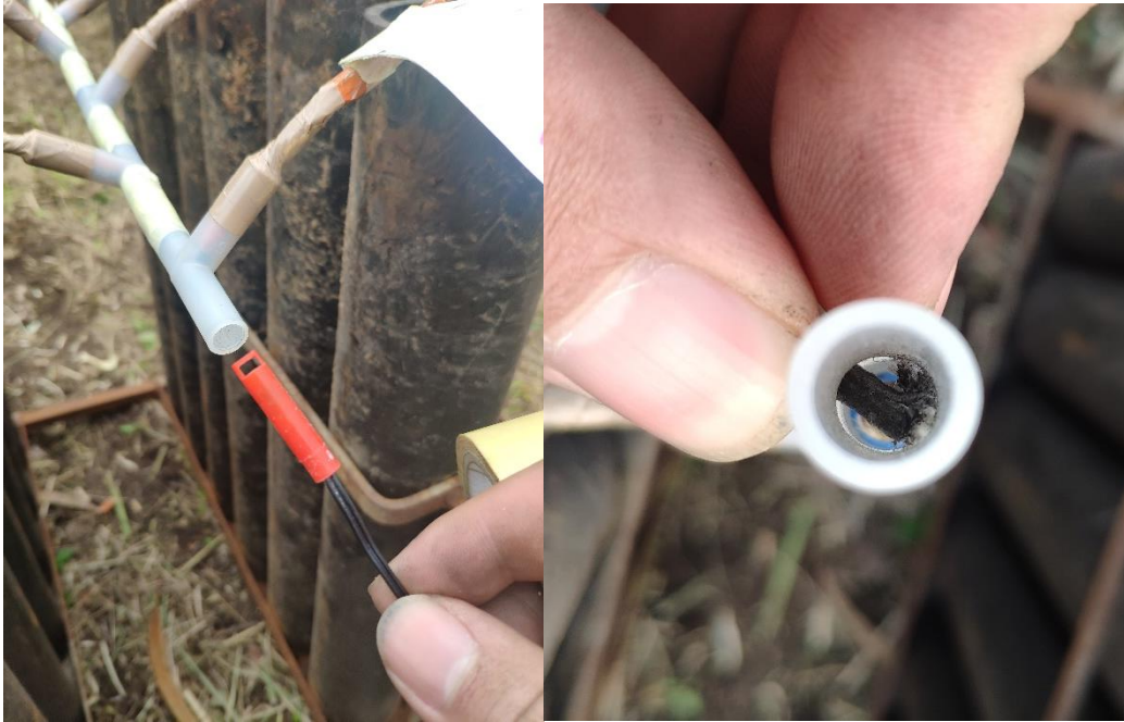
Figura 8. Inserção de um ignitor elétrico num artigo pirotécnico
