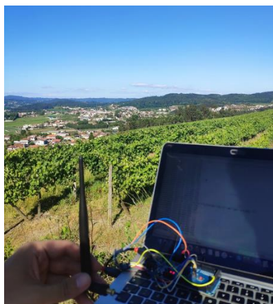
Figura 60. Ponto 6 - Quinto local de colocação do recetor para testes do módulo de rádio RA-02
