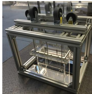
Abbildung 94: Stabilisierung des Strömungskanals am Lufteinlass und in den Etagen des Stahlbaus.
