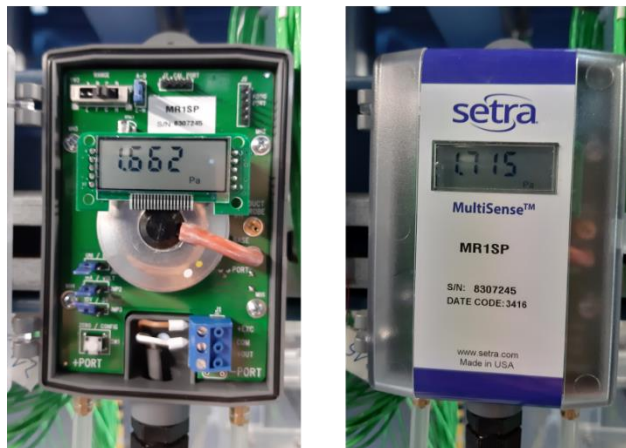
Abbildung 96: Differenzdruckaufnehmer zur Bestimmung des Druckverlustes über die Wärmeübertrager.
