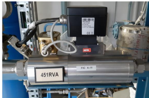
Abbildung 93: Stromquelle und Durchflusswächer zur Versorgung des Strömungskanals mit elektrischer Heizleistung und Volumenstrom.
