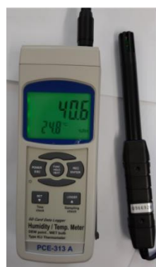
Abbildung 97: Hygrometer und Hitzdrahtanemometer zur Bestimmung von Luftfeuchte und Strömungsgeschwindigkeit.
