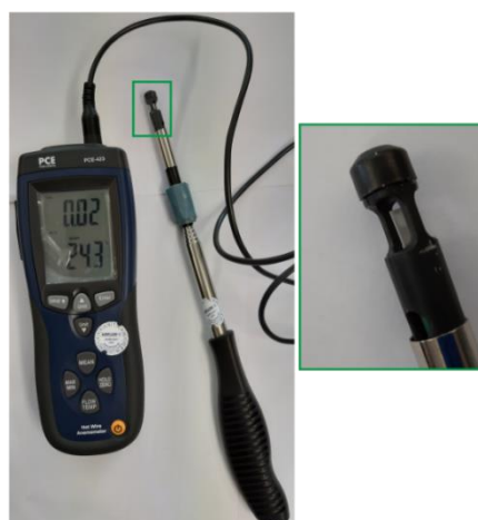
Abbildung 97: Hygrometer und Hitzdrahtanemometer zur Bestimmung von Luftfeuchte und Strömungsgeschwindigkeit.
