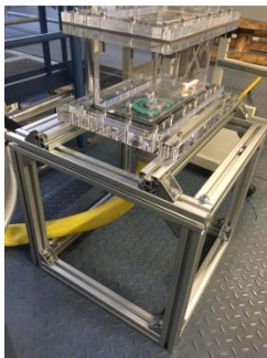
Abbildung 94: Stabilisierung des Strömungskanals am Lufteinlass und in den Etagen des Stahlbaus.
