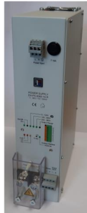
Abbildung 93: Stromquelle und Durchflusswächer zur Versorgung des Strömungskanals mit elektrischer Heizleistung und Volumenstrom.
