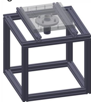
Abbildung 94: Stabilisierung des Strömungskanals am Lufteinlass und in den Etagen des Stahlbaus.
