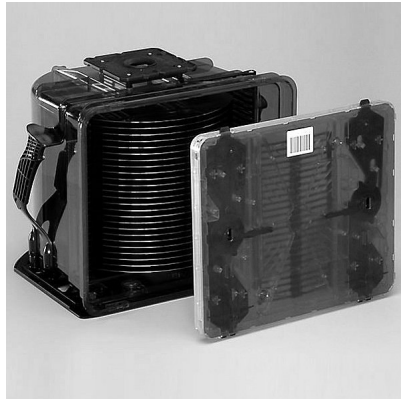
(a) Front Opening Unified Pod, kurz FOUP (Bild: RoseFinch, 2020)
