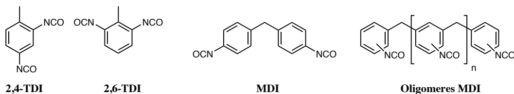
Abbildung 2.8: Beispiele von Diisocyanaten: Toluoldiisocyanat (TDI), Diphenylmethandiisocyanat (MDI) und oligomeren MDI.
