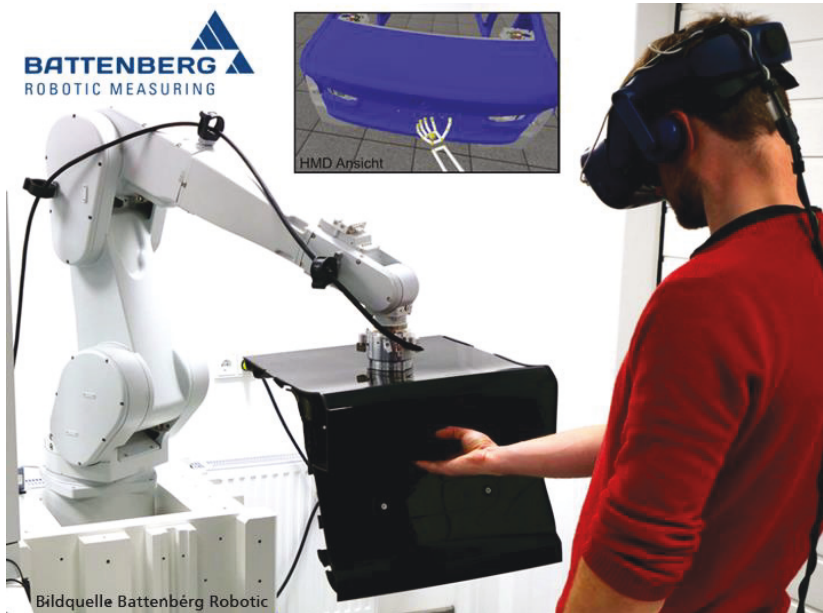
Abbildung 1: hybrider Prototyp Heckklappendemonstrator bei der Nutzung, Nutzer-Sicht durch das Head Mounted Display (oben)
