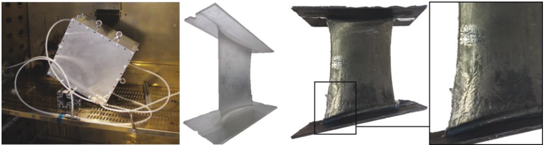
Abbildung 9: Modulares RTM-Werkzeug im Ofen bei der Infiltration (links), Reinharzabguss (Mitte) und entformtes Faser-Kunststoff-Funktionsmuster der lasttragenden Vane (rechts)
