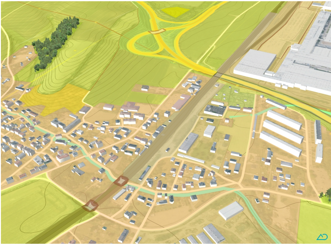
Abb. 14: BIM-Gesamtmodell mit farbiger Darstellung der Informationen des Basis-DLM im Bereich Bf Mosel
