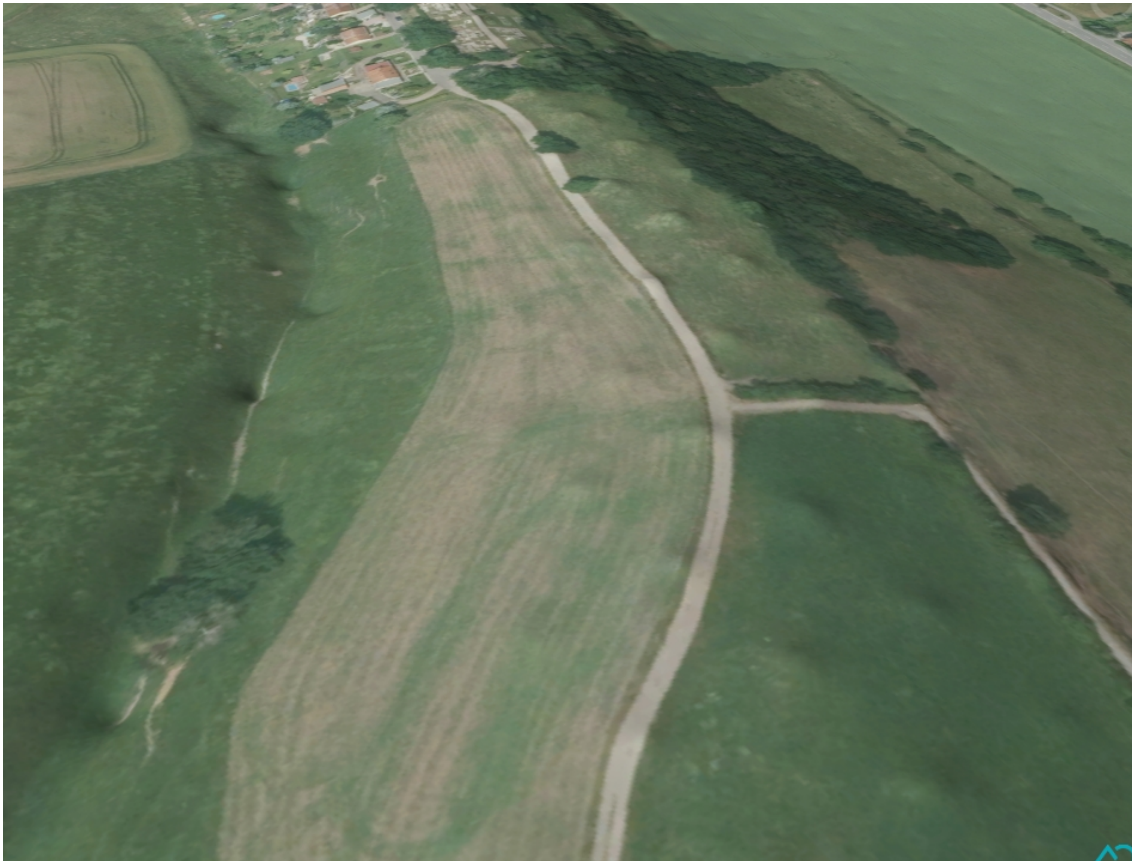
Abb. 10: Im DGM entstandene Unebenheiten bei der Einstellung Suchradius = 100 m beim IDW-Verfahren
