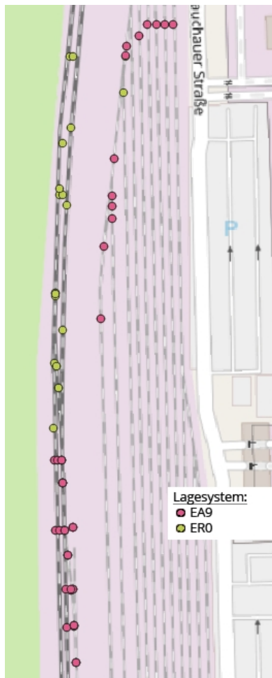
Abb. 16: Lagepunkte der aktuellen GND im nördlichen Teil des Bf Mosel (basierend auf [OSM21])
