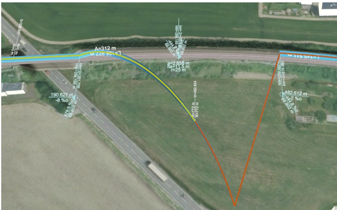
Abb. 40: Abrupter Höhensprung in einem Gleis aus der PP-XML 1.9.0.2
