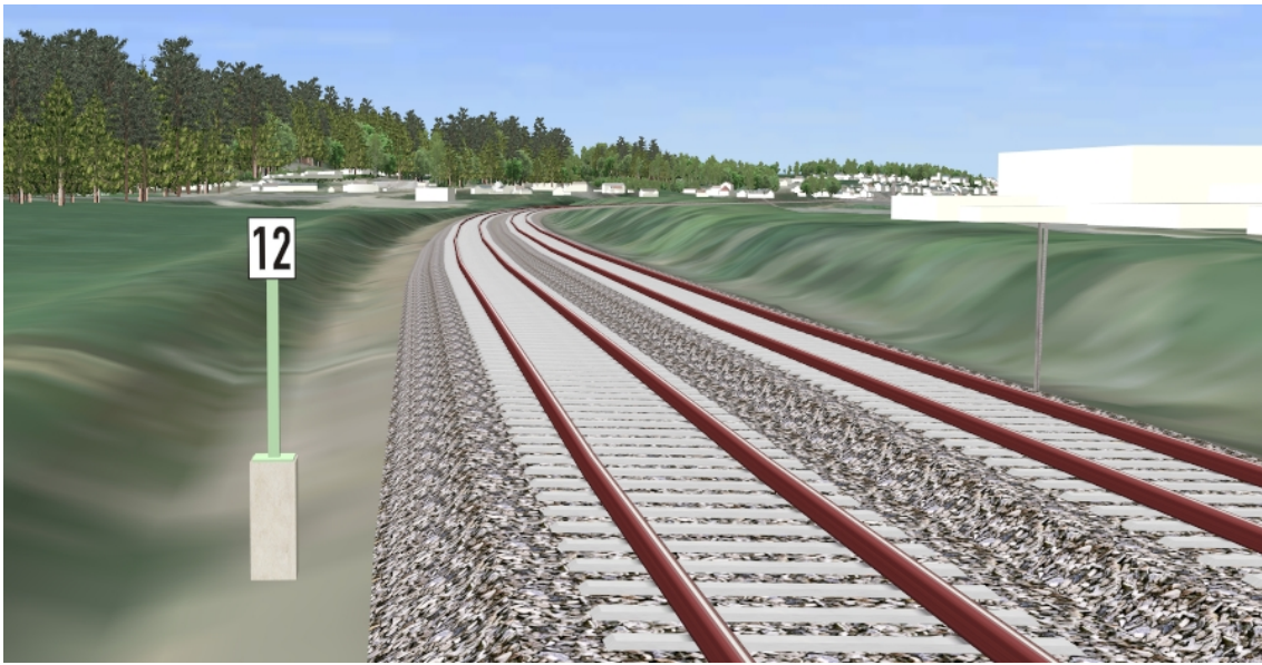
Abb. 35: Signal im BIM-Gesamtmodell (Lf 7 mit Mast und Fundament, wobei der Mast nicht bis zur Geländeoberkante reicht)
