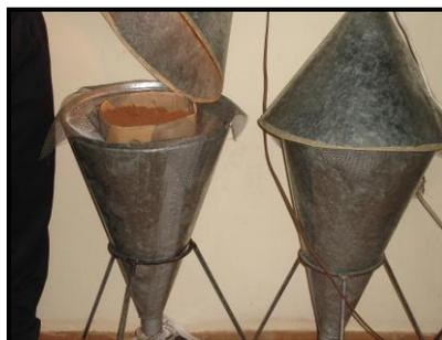
Fig.1. Detalle de la muestra de suelo, en el interior del “Embudo de Berlesse”.
