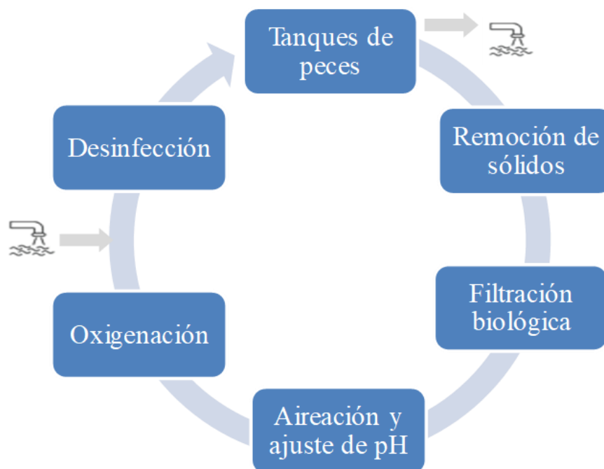
Figura 1. Ciclo de un sistema de recirculación acuícola (RAS). Fuente: elaboración propia
