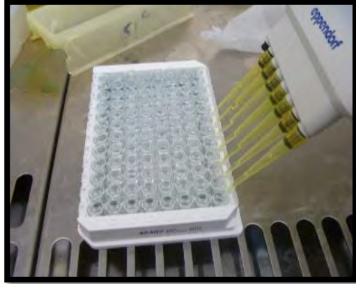
Fotografía 06. Adición de 100 \mu l Sustrato a los pocillos de la placa
