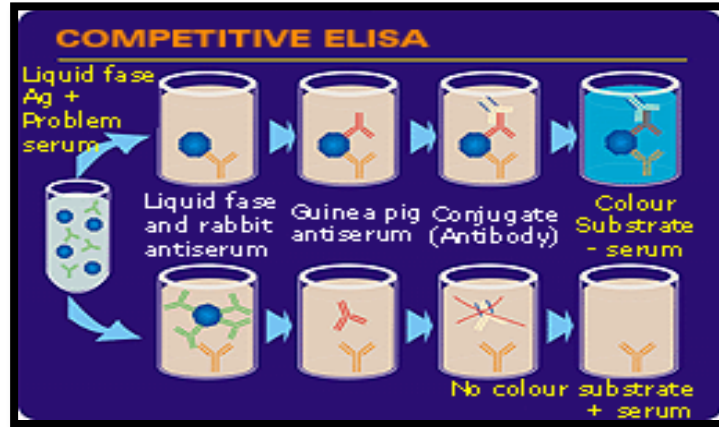
Figura 1. Pasos ELISA competitivo: (A) Pocillos impregnados con antígeno en fase sólida. (2) Adición de muestras de suero con anticuerpos (C) adición del conjugado (complejo enzima-Ac) y posteriormente Sustrato TMB. En este caso, la ausencia del color significa una muestra positiva.
