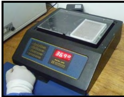
Fotografía 04. Incubación de la placa a 37°C por 2 horas.
