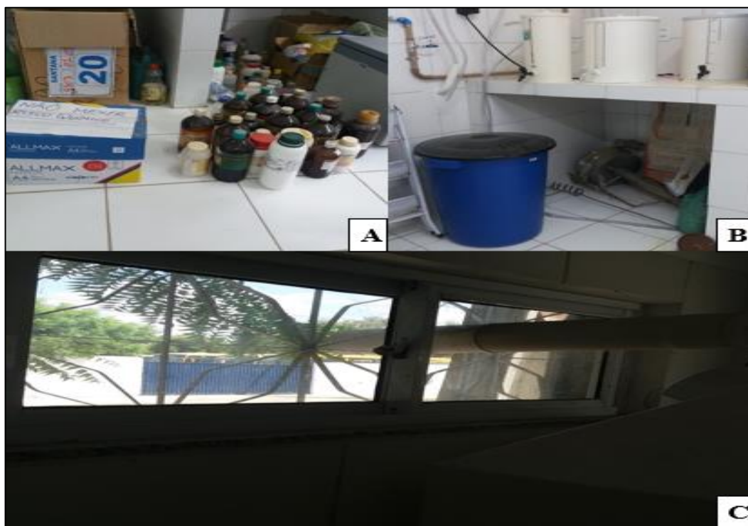
Figura 2 – Consequências da falta de gerenciamento de resíduos laboratoriais Fonte: Elaborado pelo o autor. A- Resíduos sem identificação B- Armazenamento inadequado da água destilada e C- Dispersão de gases inadequados.
