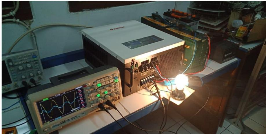
**Gambar 3.** Pengujian laboratorium aliran daya pada *Off-grid Photovoltaic Solar Power System*
