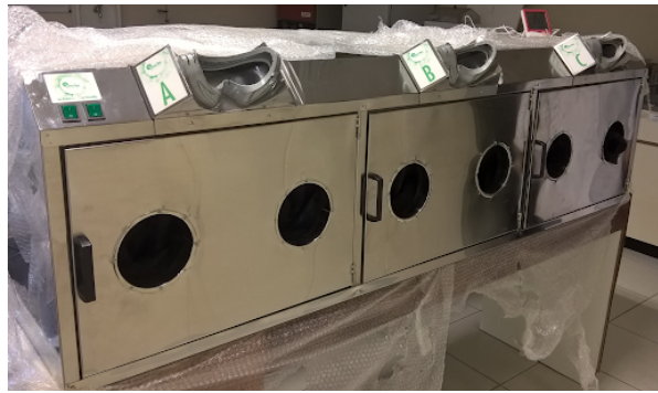
FIGURA 2: Câmara entomológica da Embrapa Mandioca e Fruticultura utilizada nos experimentos de dispersão. São visíveis as 3 portas de acesso e os respectivos visores.
