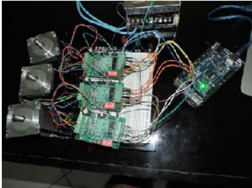
Figura 8: Montagem do circuito completo com três motores.
