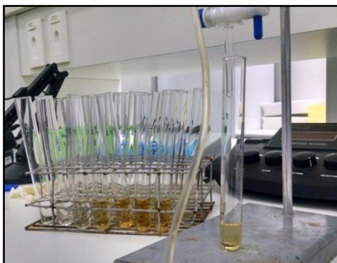
Figura 2 - Eluição da solução concentrada através da coluna de Sepharose CL - 4B
