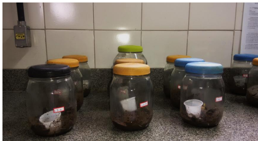
Figura 3- Experimento de Respirometria com amostras de material orgânico submetido a compostagem (Branco, Controle (Solo puro), Tratamento 1 (Compostagem de Casca de Laranja) e Tratamento 2 (Compostagem de Resíduo de Poda).
