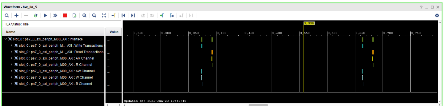
Figura 4.6 Analizador Lógico conectado a los buses del protocolo AXI, comunicación entre procesador y FPGA con UART
