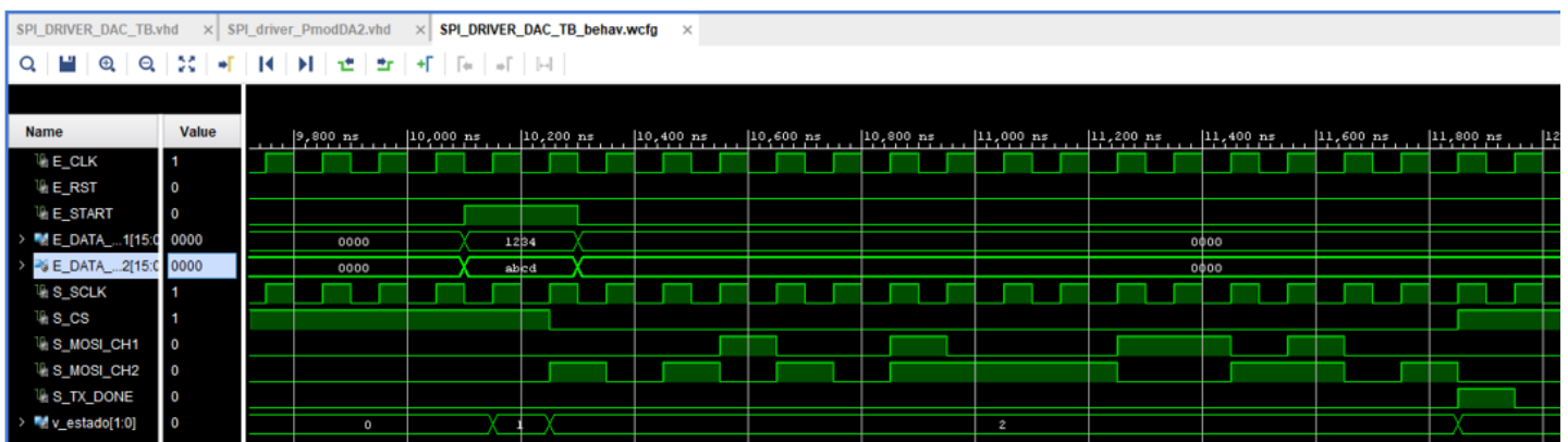
Figura 3.21 Simulación funcional del módulo driver del Pmod DA2
