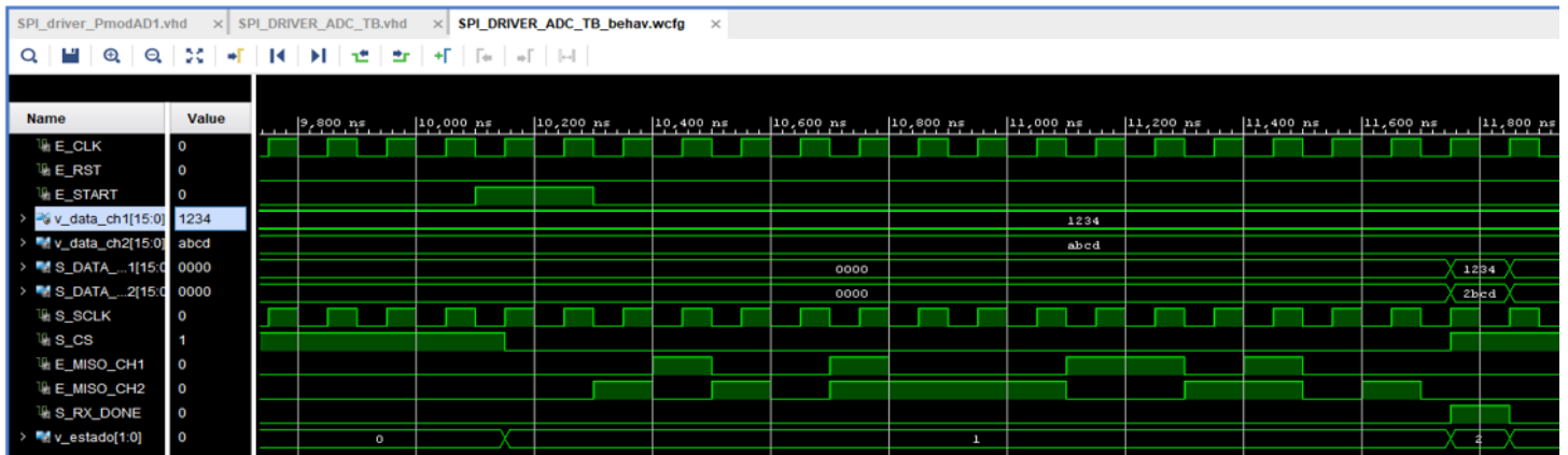
Figura 3.25 Simulación funcional del módulo driver del Pmod AD1
