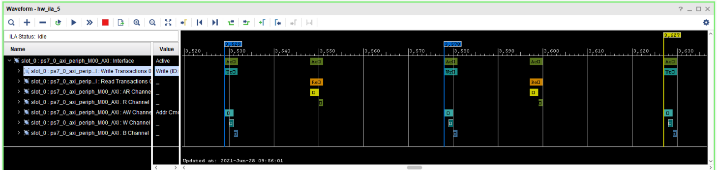
Figura 4.7 Analizador Lógico conectado a los buses del protocolo AXI, comunicación entre procesador y FPGA sin UART
