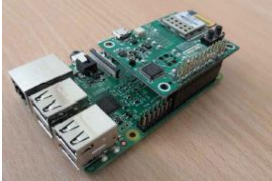
Figura 36. Raspberry Pi con tarjeta de desarrollo (puerta de enlace) [12]
