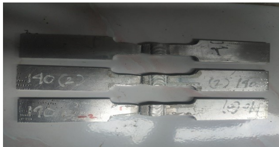
Gambar 13. Spesimen uji tarik 140 A setelah putus
