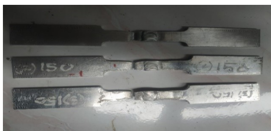
Gambar 14. Spesimen uji tarik 150 A setelah putus
