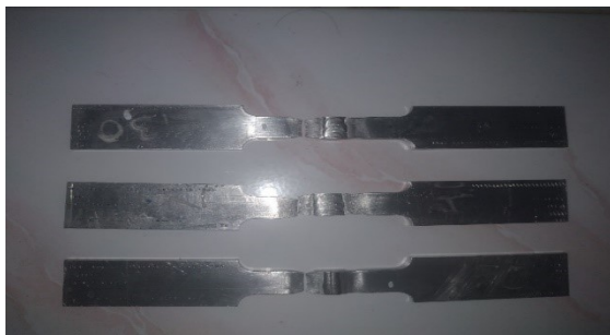
Gambar 12. Spesimen uji tarik 130 A setelah putus
