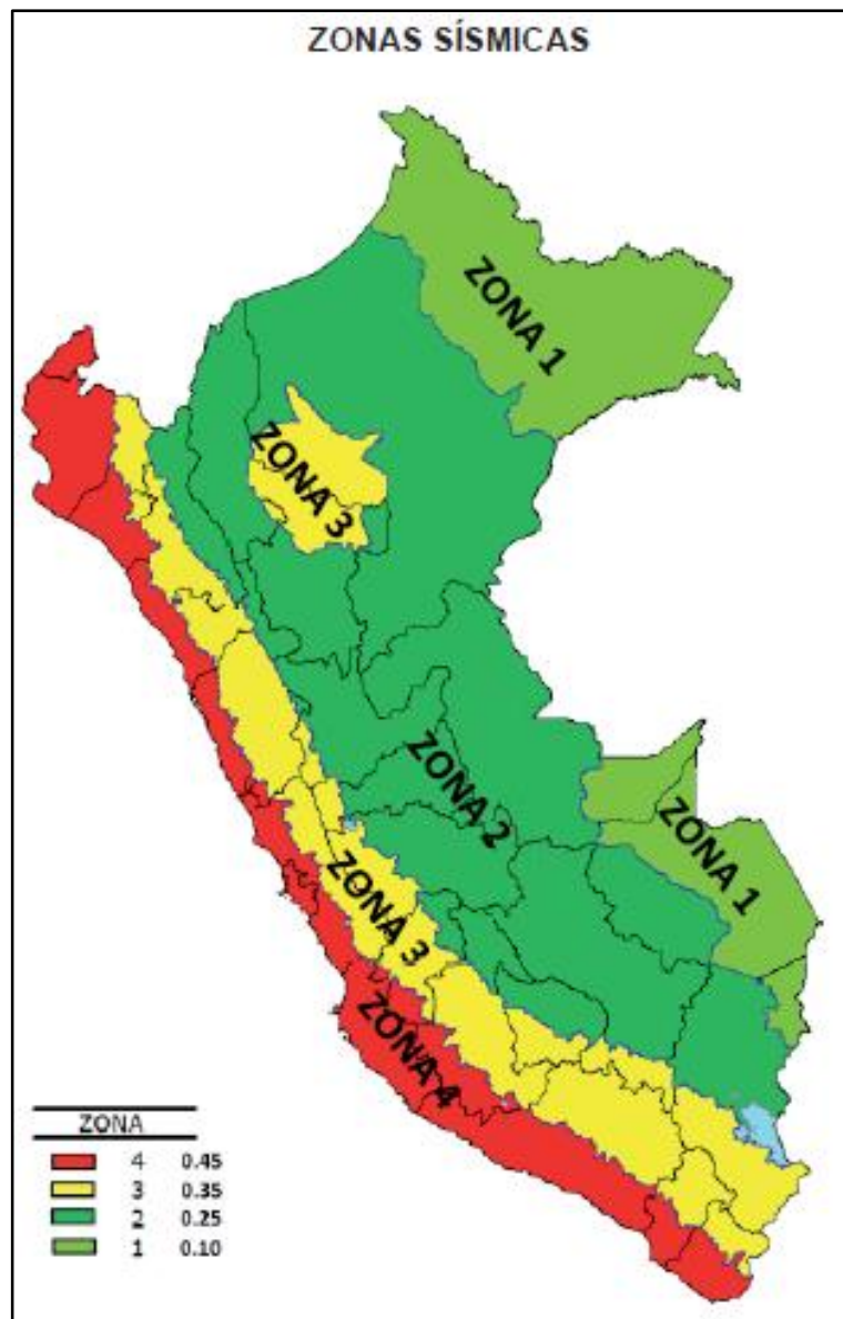
Figura N° 7. Zonificación sísmica del Perú
